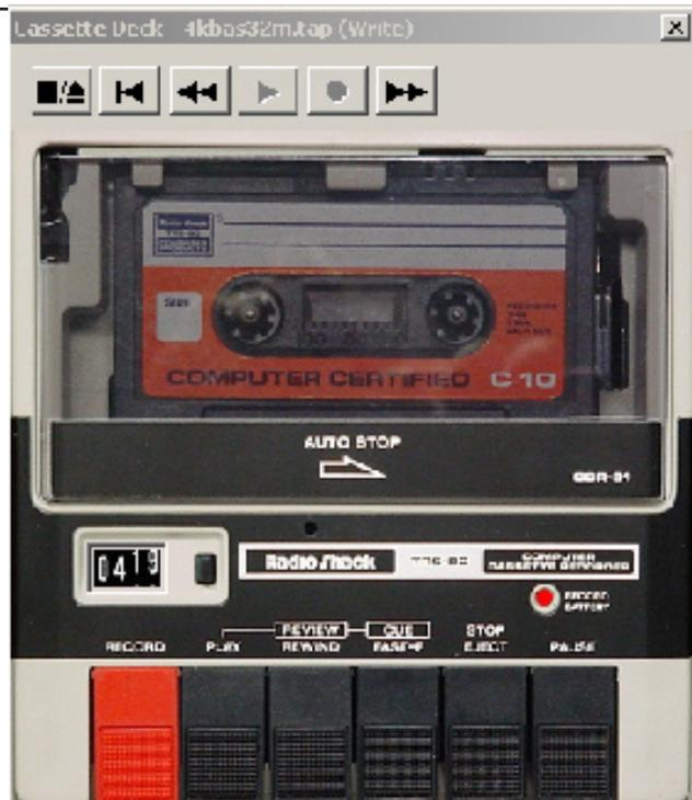
Il lettore di cassette audio. Notare la presenza del contatore di giri; invece i tasti del registratore non servono nell'emulazione che fa uso della striscia di comandi visibile nella parte alta.
