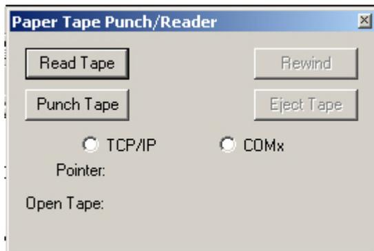
*La maschera, fin troppo spartana, del lettore/perforatore di nastri cartacei. Come si intuisce dai controlli presenti, è anche un sistema per passare dei dati all'emulatore attraverso la comunicazione via rete o via seriale.*
