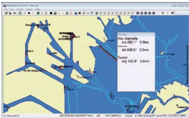
Ricezione del protocollo Automatic Identification System (AIS) con ShipPlotter - circa 20 navi individuate a Porto Marghera
