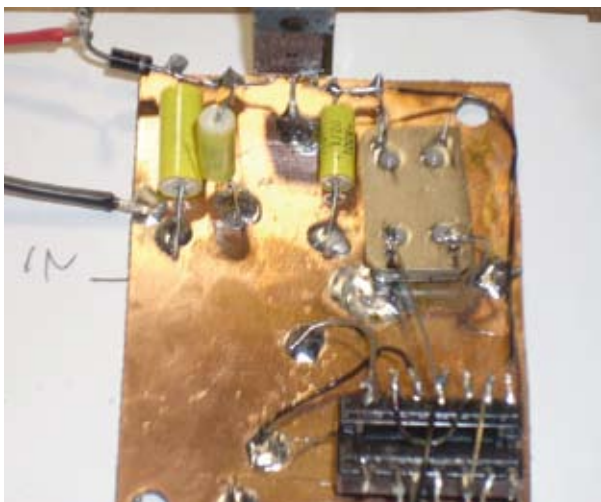
Vista del cablaggio volante sul divisore
