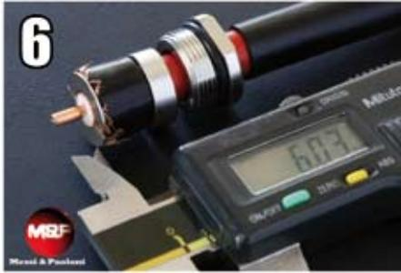
Tagliare e rimuovere il nastro e il dielettrico per una lunghezza pari a quella illustrata sul calibro, liberando il conduttore centrale.
