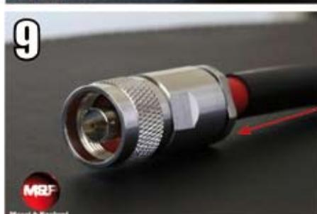
Inserire il connettore ed avvitare con cura, fino ad andare a serrare l'o-ring di battuta. All'interno del connettore, il cilindro di gomma C (figura 2) si espande garantendo un'ottimale tenuta contro l'umidità e una perfetta chiusura a massa.
