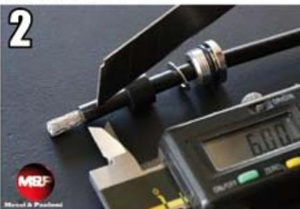
Eseguito il primo taglio, come in figura 2, ruotare il cavo di 180 gradi e farne un secondo identico, per facilitare l'inserimento del componente D (figura 3 e 4).
