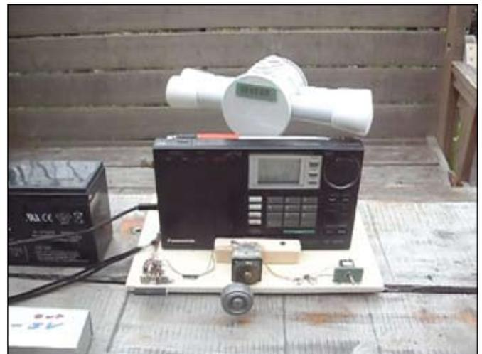
do molto più sostanzioso, si trasferirà per induzione all'antenna di ferrite interna al ricevitore con notevole vantaggio sotto il profilo del rendimento dell'apparecchio radio.
