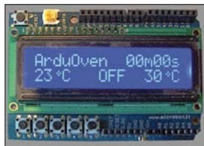
Foto 3 - Display di controllo del forno
