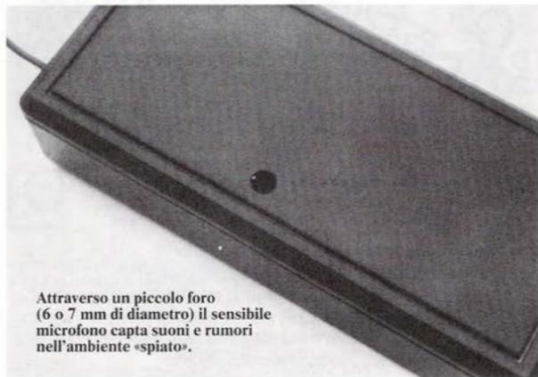
Attraverso un piccolo foro (6 o 7 mm di diametro) il sensibile microfono capta suoni e rumori nell'ambiente «spiato».
