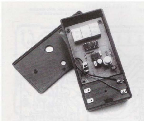
Il secondo integrato, siglato IC2, è un ICM 7555 (equivalente al NE555, ma in tecnologia CMOS) che sfruttiamo per realizzare un oscillatore ad onda quadrata alla frequenza di 40 Hz circa.
