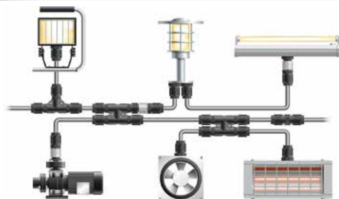
Il cavo viene collegato in modo rapido, semplice e senza utensili
