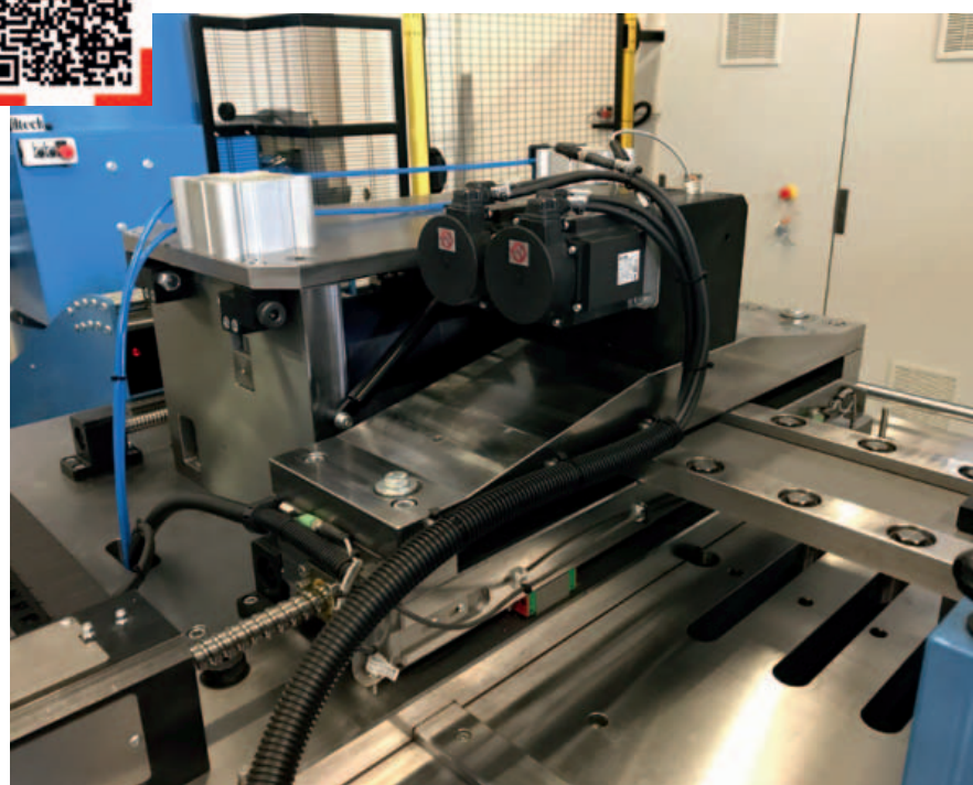
La LT 320, macchina completamente automatica per la costruzione e assemblaggio di nuclei magnetici
