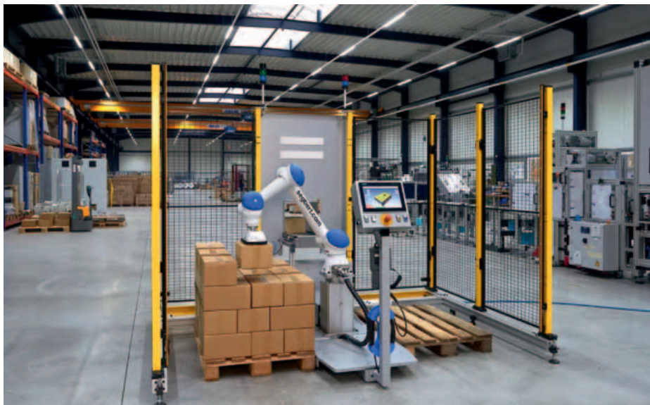
La serie Motoman HC (Human Collaborative) comprende robot ibridi idonei alla collaborazione con l'uomo che possono funzionare ad alta velocità o a una velocità sicura e ridotta ogni volta che una persona entra nell'area di lavoro
