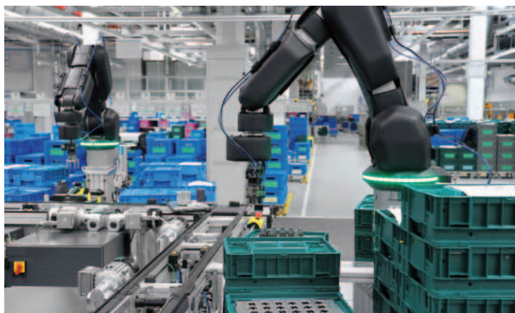
Apas - Automatic Production Assistant è un robot collaborativo pensato per svolgere in autonomia attività ripetitive
