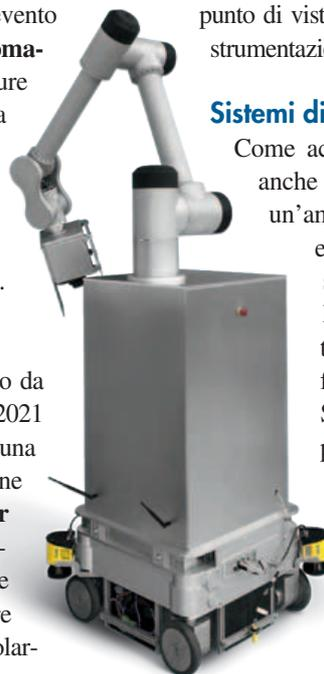
Un'applicazione di robotica mobile di Automationware, con un braccio robotico collocato su un AGV
