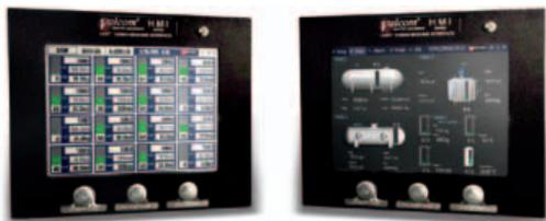
Il sistema HMI di Terranova visualizza in tempo reale le variabili di processo e dispone di funzioni di data-logging e alarm-setting
