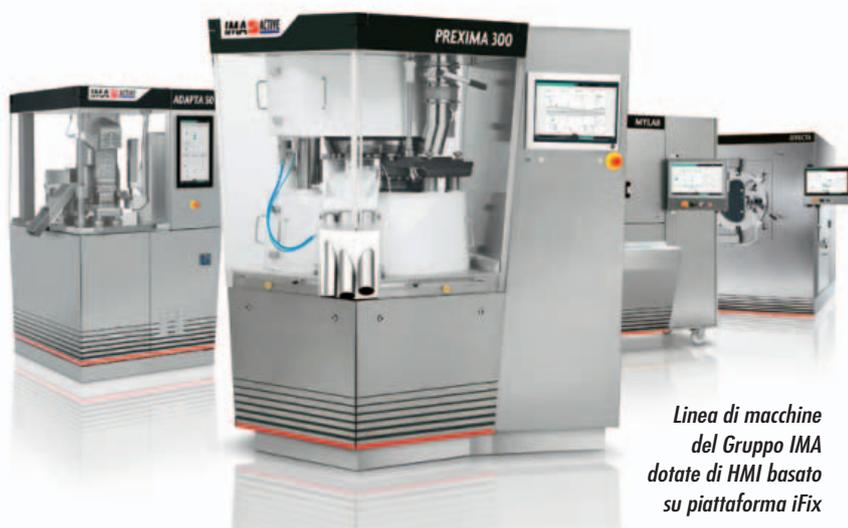
Linea di macchine del Gruppo IMA dotate di HMI basato su piattaforma iFix
