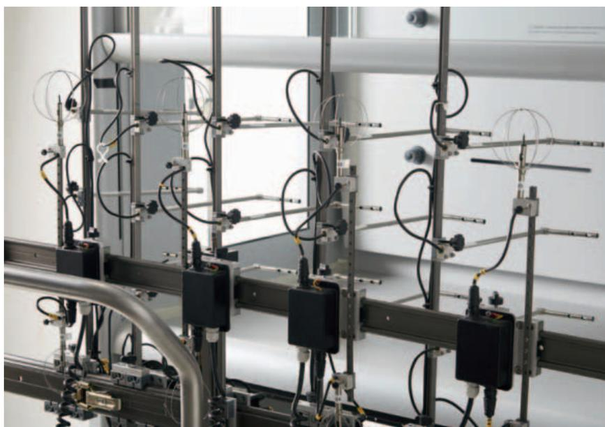
*Strumentazione utilizzata per la mappatura dei flussi frontali e omnidirezionali sul fronte di aspirazione di una cappa nel corso dei test per verificarne la capacità di contenimento*
