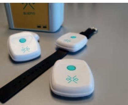
Basato sulla release 5.1 dello standard Bluetooth Low Energy, il Beacon sviluppato da Bluepyc è flessibile al settaggio
