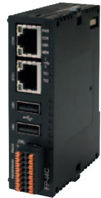
*Il gateway IIOT FP-I4C di Panasonic Industry Italia si interfaccia con i PLC Panasonic e altre apparecchiature di campo tramite il protocollo Modbus RTU/TCP*
