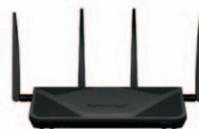
**Il router RT2600ac di Synology è alimentato dal processore dual-core 1.7 GHz e certificato 802.11ac Wave 2**
