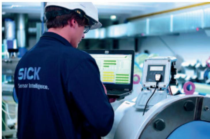
*La modalità power-to-gas, che prevede l'aggiunta di idrogeno nella rete di gas naturale, può avvalersi dell'idoneità dei misuratori di portata gas a ultrasuoni di Sick*
