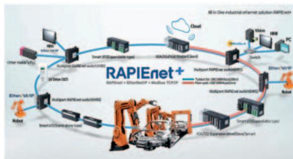
La rete Gigabit Industrial Network di LS Electric gestisce i protocolli Rapienet, Modbus TCP/IP, Ethernet/IP, OPC-UA, IOT
