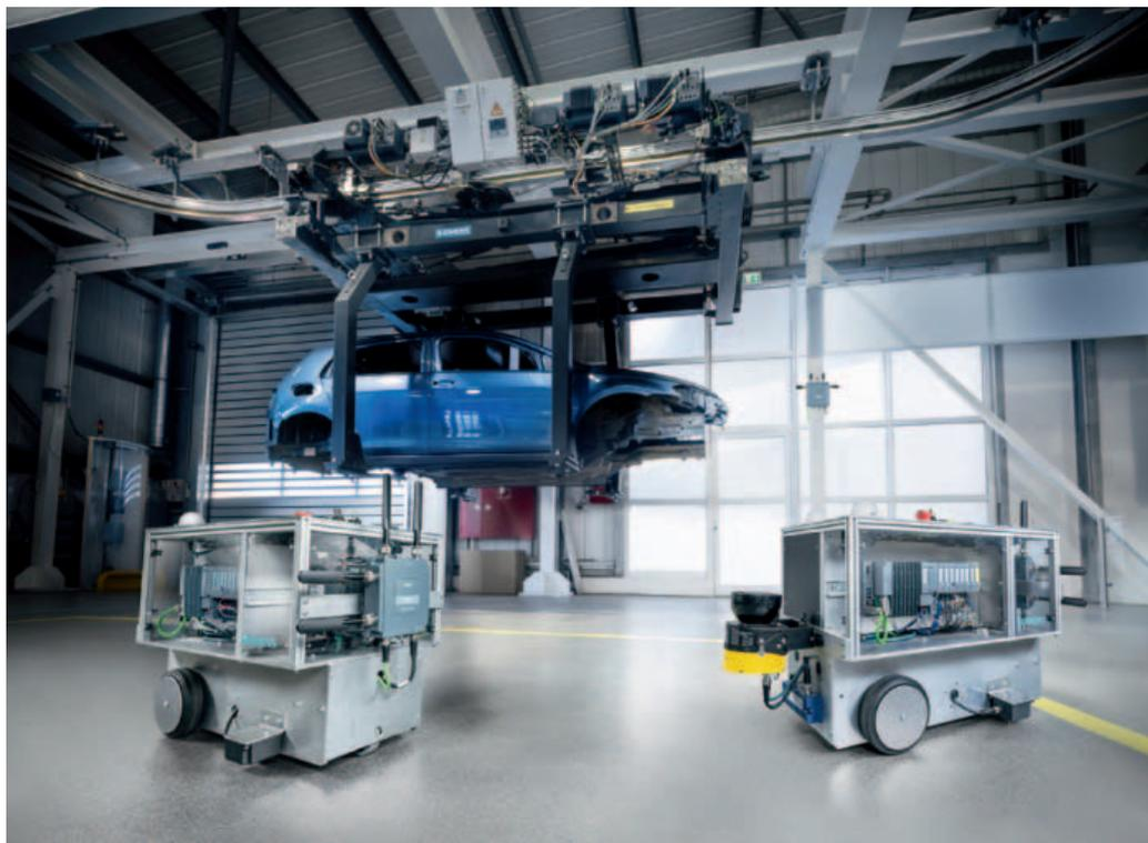
*Il router industriale 5G Scalance MUM856-1 di Siemens montato su degli AGV (visibile chiaramente sulla parte anteriore dell'AGV di sinistra, fonte: Siemens)*
