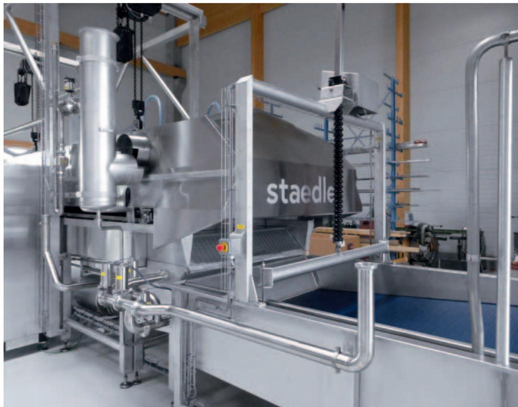
Con il sensore di conducibilità LDL rileviamo i valori di processo, temperatura e conducibilità utilizzando un singolo filo. Tramite IO-Link il misuratore di portata magnetico SM trasferisce i valori rilevati e la velocità al sistema di controllo mediante un'unica porta di output.
