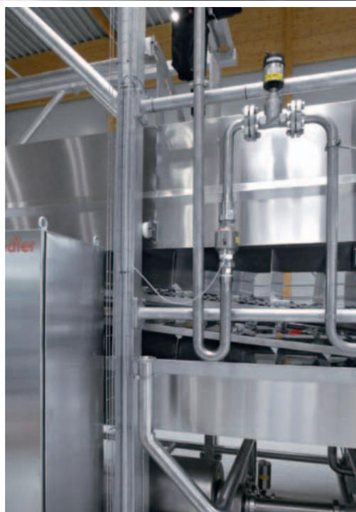
*Il misuratore di portata magnetico SM2100 viene utilizzato per rilevare la velocità del flusso attuale e il volume totale di acqua fornita al sistema. Anche in questo caso, entrambi i valori di misura vengono trasferiti al sistema di controllo tramite IO-Link*
