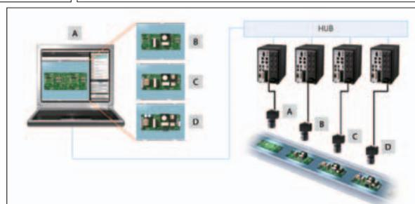
Il sistema di visione Omron può essere utilizzato sulla linea produttiva per verificare automaticamente e velocemente la conformità e rilevare i difetti del prodotto
