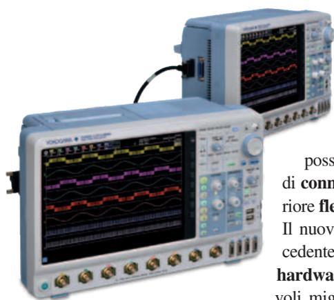
L'oscilloscopio a segnali misti DLM5000 integra fino a otto canali analogici, logica a 32 bit e un ampio schermo touch che permette un facile monitoraggio delle forme d'onda
