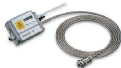
Il nuovo pirometro CTratio 1M di Optris rileva la temperatura del metallo misurando il rapporto tra i segnali di 2 rilevatori IR a lunghezze d'onda di 0,7 e 1,1 μm
