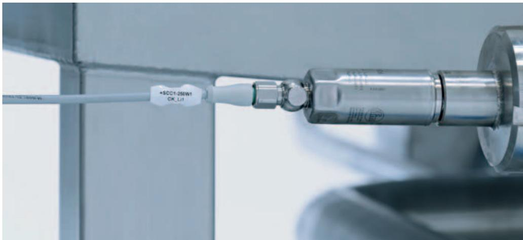
*I sensori di pressione PM utilizzano la pressione idrostatica per rilevare il livello del bagno di cottura e del bagno di raffreddamento*
