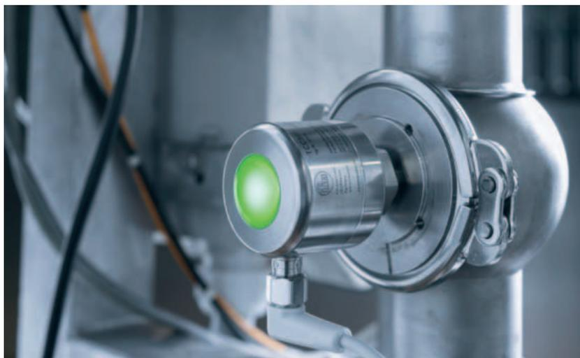
*Sarà utilizzato in futuro da Staedler: il sensore di temperatura TCC è dotato di funzione di auto-monitoraggio, il che significa che i tempi che intercorrono tra una calibrazione e la successiva possono essere estesi. Le deviazioni vengono riconosciute automaticamente e segnalate mediante un segnale di commutazione e un led*
