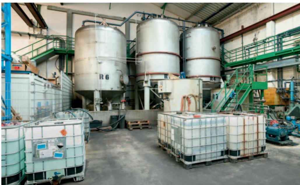
Serbatoio per la separazione delle emulsioni ricevute
