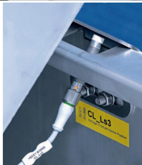
*Dopo avere pulito manualmente e reinstallato il tappeto, la produzione può essere ripresa solo previo consenso del sensore induttivo*
