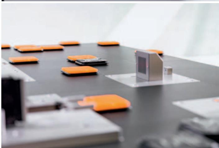
B&R, che consente di sincronizzare le navette con precisione al **microsecondo**, coordinandole in stretto determinismo con servo-assi, robot, sistemi Track e sistemi di visione. Sostituiti algoritmi assicurano che le navette seguano un percorso ottimale, evitando collisioni e riducendo al minimo il consumo di energia.
