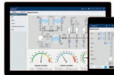
*Ignition è una piattaforma di collegamento Inductive Automation per applicazioni in ambito industriale come Scada-HMI, IIOT, Mes, ERP e Cloud*
