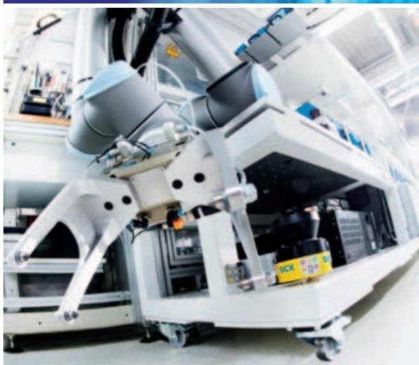
*Con un sistema lidar, un emettitore laser effettua la scansione dello spazio, illuminando gli oggetti presenti nel campo di rilevamento, quindi un sensore riceve la radiazione riflessa dagli oggetti e l'elettronica di elaborazione può rilevare presenza, distanza, posizione dell'obiettivo della rilevazione*
