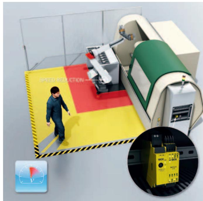
*Il sistema di sicurezza sBot Speed di Sick è in grado di regolare la velocità, in modo adatto a garantire la massima sicurezza di persone e cose, in applicazioni basate su sistemi automatici mobili, macchinari in movimento o robotica cooperativa*
