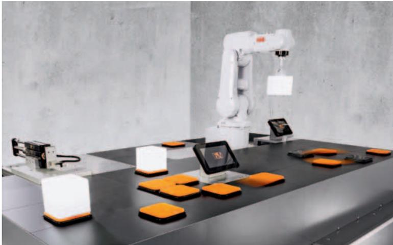
*La sincronizzazione, con precisione al microsecondo, consente ad Acopos 6D di coordinarsi con assi, robot, sensori e altri sistemi di trasporto*
