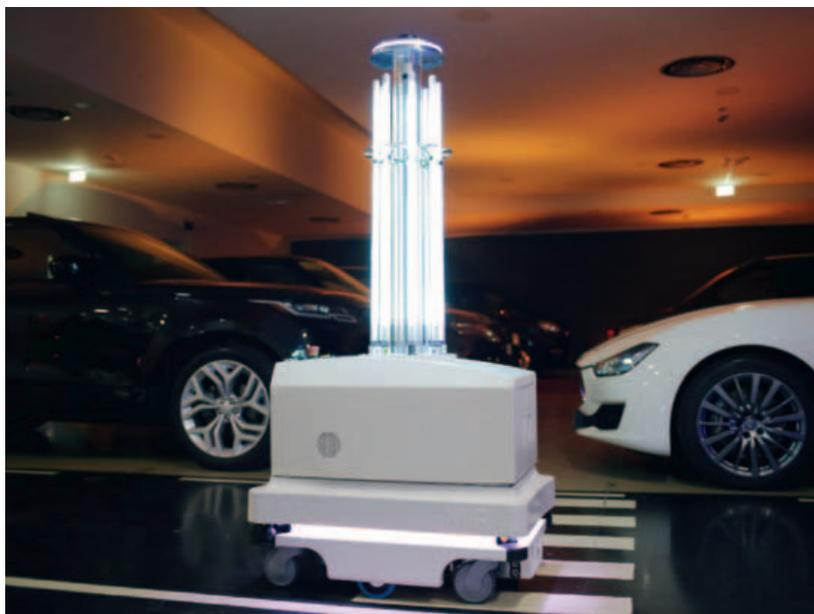
*PHS ha installato a bordo dei robot MiR un sistema che si basa su lampade a scarica in vapore di mercurio a bassa pressione in grado di emettere radiazioni UV-C a lunghezza d'onda corta (da 100 nm a 280 nm)*
