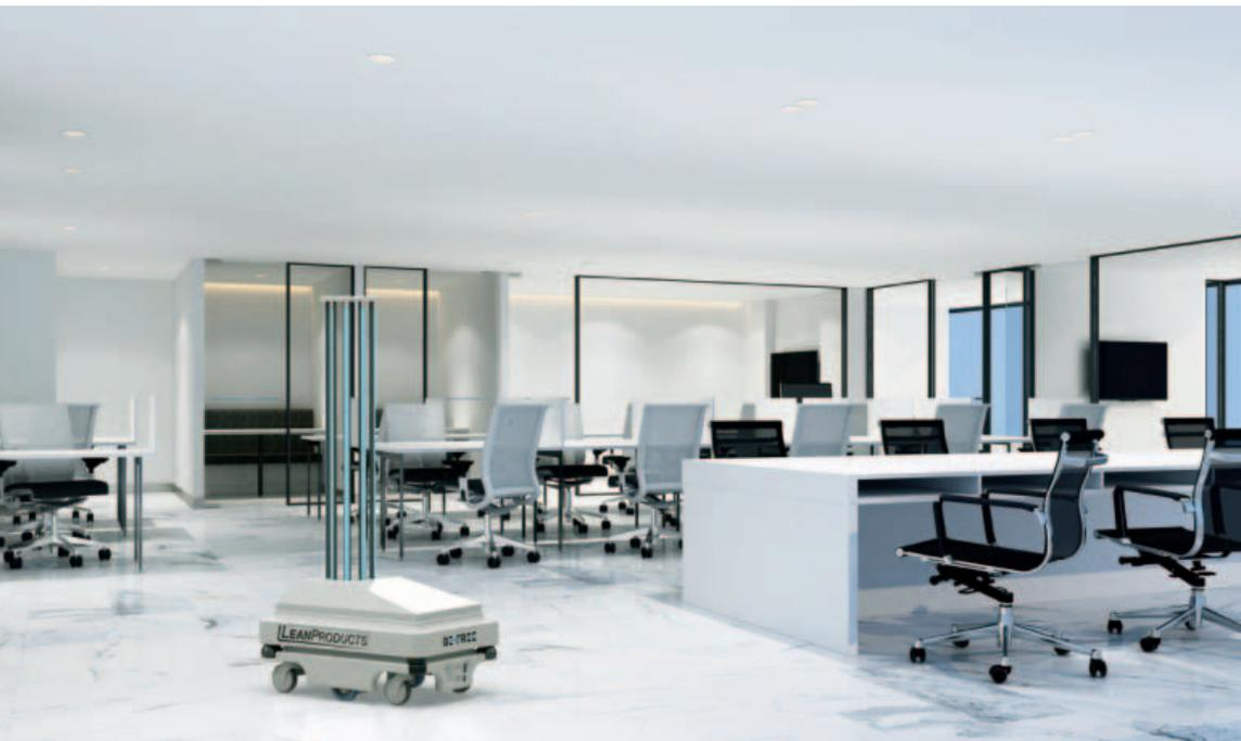
*Il sistema di emissione dei raggi UV scelto per BeFree è basato su tecnologia led, che garantisce un ciclo di vita utile di oltre 20.000 ore*
