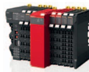
*Con il software Sysmac Studio, il controllore stand alone NX di Omron collega fino a 63 slice, con un'ampia disponibilità di ingressi e uscite standard o di sicurezza, con funzionalità digitali o analogiche*
