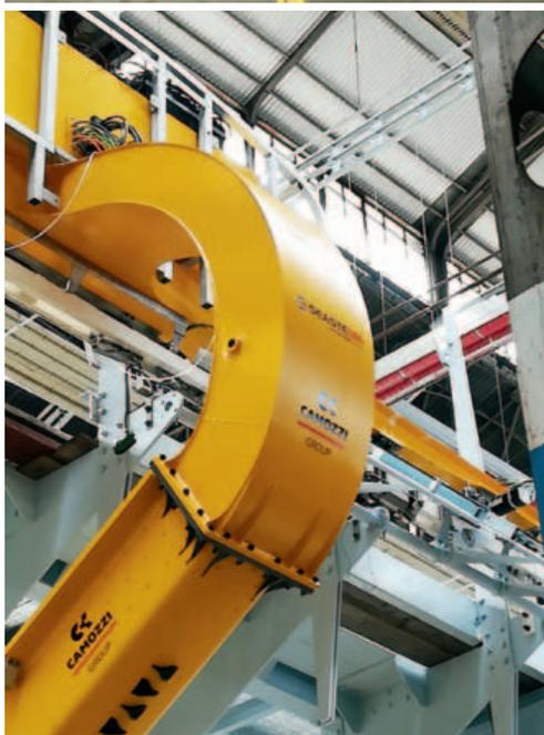
*Le travi in pezzi unici che permetteranno l'ispezione dell'impalcato sono state realizzate con tecnologie provenienti dal settore aerospaziale*
