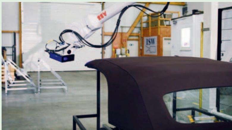
*Il sistema ShapeDrive di wenglor ricostruisce l'intera geometria dei tettucci sotto forma di nuvola di punti con un'accuratezza fino a 9 µm sull'asse Z*
