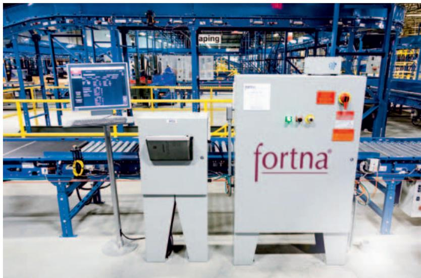
Ogni linea è dotata di un pannello di controllo multi-touch CP3919 montato su palo che viene collegato al control cabinet tramite il CP-Link 4 One Cable Display Link (fonte: Beckhoff Automation, USA)
