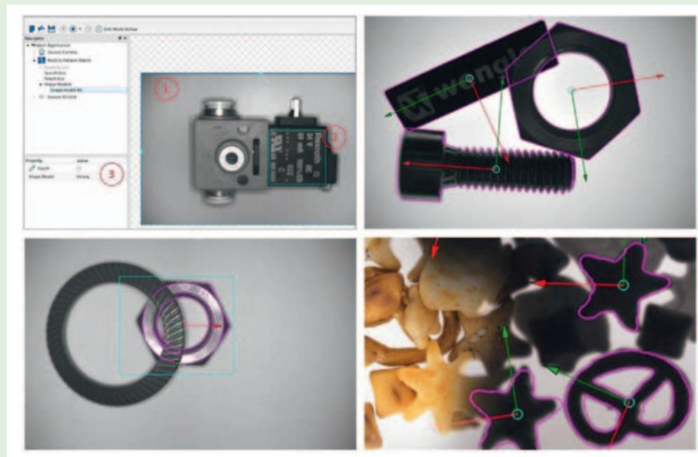
*L'algoritmo di pattern matching consente di rilevare la presenza di più oggetti identici insieme ad altri di forma diversa e di riconoscerli tutti simultaneamente nella stessa inquadratura*
