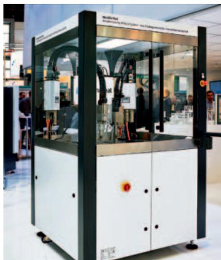
*La nuova unità di trattamento al plasma è molto compatta in quanto non richiede più un robot a 6 assi o ulteriori assi lineari (fonte: Plasmatreat, Germany)*
