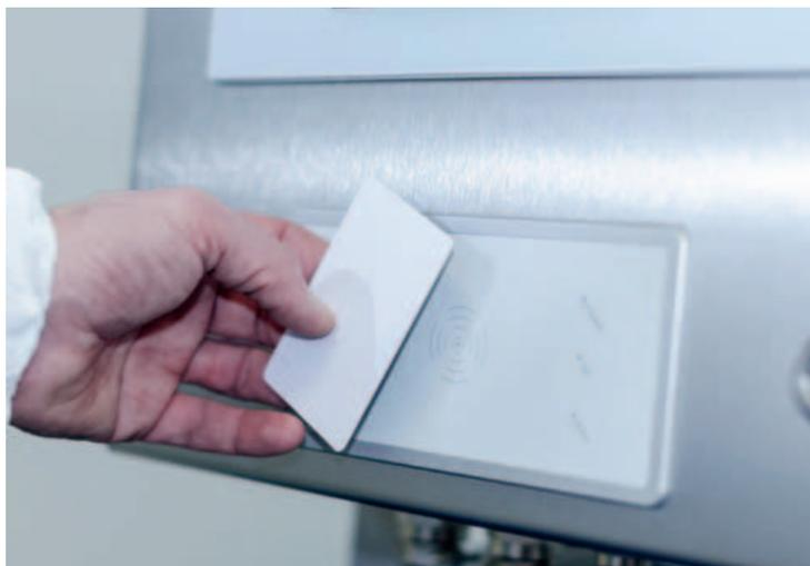
Lettori RFID per controllo accessi veloce e sicuro su Sistemi HMI installati in area pericolosa
