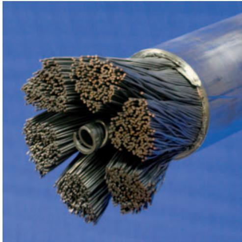
*Uno dei cavi conduttori delle bobine del campo toroidale di Iter, con il canale centrale per l'elio criogenico (fonte: Iter)*
