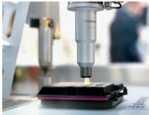
Non c'è bisogno di spostare il getto di plasma: un mover planare flottante porta il pezzo in lavorazione esattamente in posizione per il trattamento della superficie (fonte: Plasmatrete, Germany)
