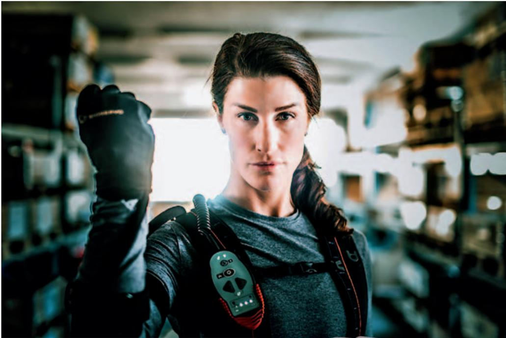
*Il sistema Ironhand di Bioservo è in grado di assistere il movimento naturale delle singole dita con la forza generata da compatti e potenti attuatori elettrici, utilizzando i micromotori a corrente continua 1741...CXR prodotti da Faulhaber*
