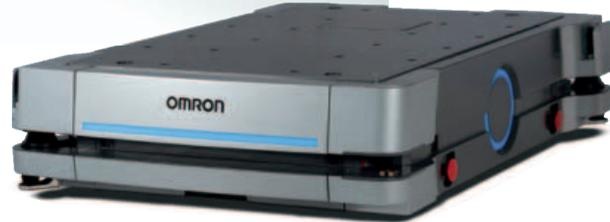
*Con un grado di autonomia superiore ai classici AGV, i nuovi robot mobili Omron sono in grado di navigare in modo autonomo, evitare gli ostacoli e calcolare automaticamente il percorso migliore*
