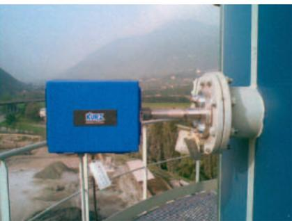
*Il misuratore K-BAR 2000B è adattabile a qualsiasi dimensione di camino e profilo di flusso*
