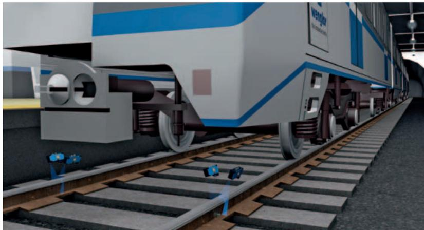
In base al posizionamento, i sensori weCat3D di Wenglor possono analizzare il profilo delle ruote dei vagoni, oppure quello di rotaia e massicciata
