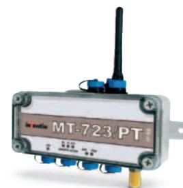
Il modulo MT 723PT di Inventia ha a bordo di 4-6 input digitali/contatori, 2 output digitali e 3 input analogici
