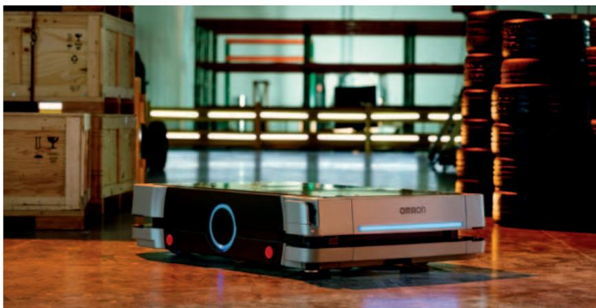
*I nuovi robot mobili di Omron sono in grado di collaborare in modo sicuro con gli operatori umani e possono trasportare una tonnellata e mezza di carico utile, in impianti o magazzini*
