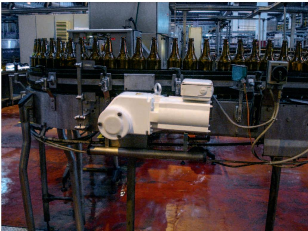
*Uno dei sistemi di azionamento prodotti da Danfoss e utilizzati per movimentare la linea di imbottigliamento di Birra Peroni*
