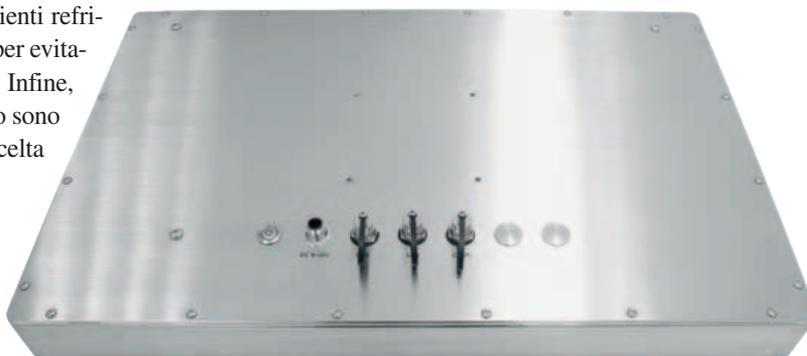
*I dispositivi per uso alimentare devono possedere una struttura adatta ai frequenti lavaggi, in acciaio inossidabile a bassissima porosità, facilmente igienizzabile, con protezione IP69K su tutti i lati per l'acqua ad alta temperatura e in pressione*
