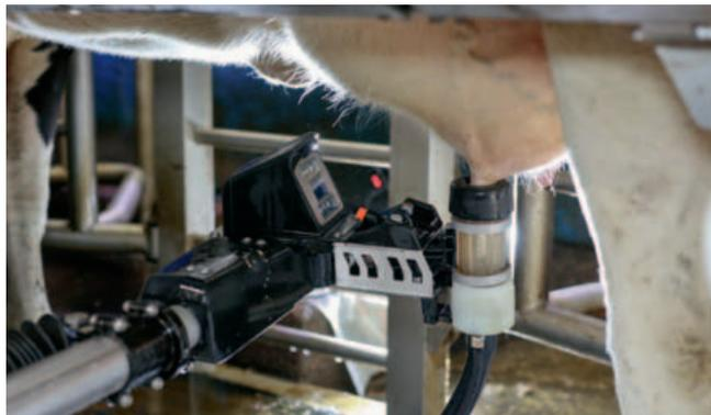
*Il braccio multifunzione del robot nel processo di mungitura è posizionato correttamente grazie al sensore di visione, che permette di portare a termine con successo anche diverse altre fasi del processo di mungitura*
