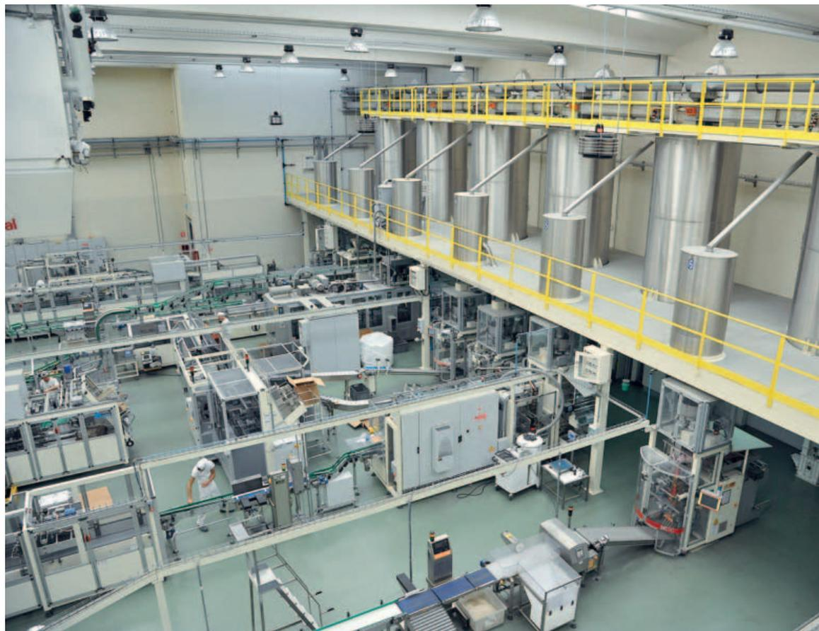
L'impianto di S.P. può lavorare diverse tipologie e qualità di riso, che sono sottoposte a lavorazioni di sbramatura-pulitura, sbiancatura e s...
