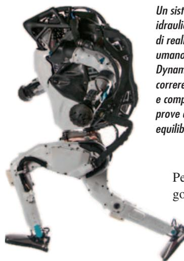
*Un sistema di attuazione idraulica ha permesso di realizzare il robot umanoide Atlas di Boston Dynamics, che è capace di correre su terreni scoscesi e compiere impegnative prove di agilità ed equilibrio*
