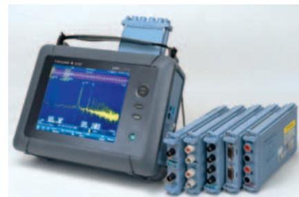
Lo Yokogawa DL350 ScopeCorder è uno strumento di misura portatile a batteria per l'acquisizione, la visualizzazione, la registrazione e l'analisi di parametri
