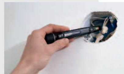
*Il rilevatore di tensione VP50-2 è in grado di misurare e segnalare la presenza di tensione*
