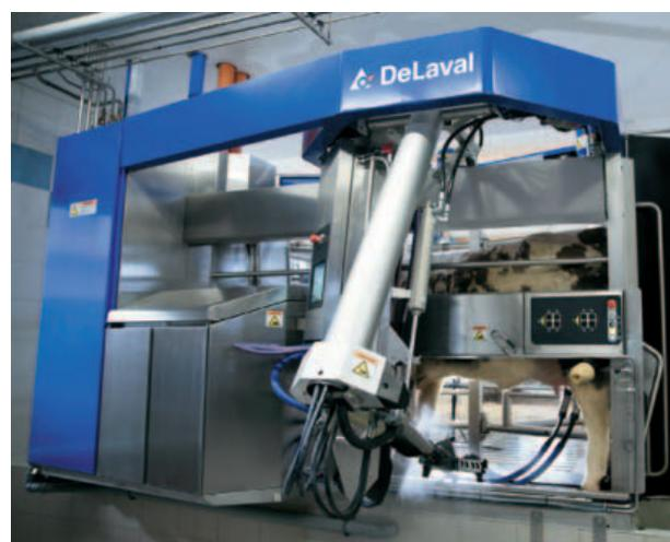
Il sistema di mungitura DeLaval VMS V300 utilizza l'innovativo sensore O3D di IFM
