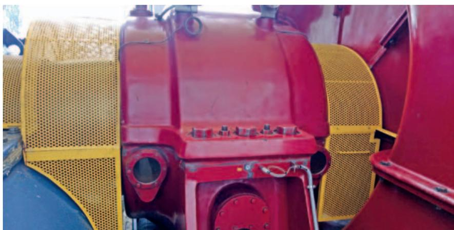
*Turbina Pelton con portata nominale 4 m<sup>3</sup>/s, salto motore e nominale 966 m e potenza meccanica 35.375 kW*
