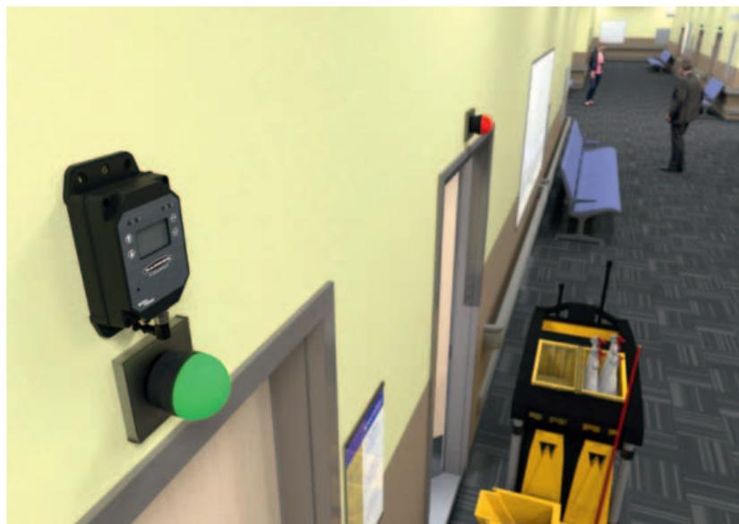
*Un'applicazione del controller wireless DXM 1200, che raccoglie e visualizza informazioni sulla pulizia di un corridoio di una struttura sanitaria*
