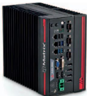
*I PC embedded della serie MVP-5100-MXM sono dotati di uno slot MXM che consente l'installazione di una GPU Nvidia a scelta tra i modelli della serie Quadro*
