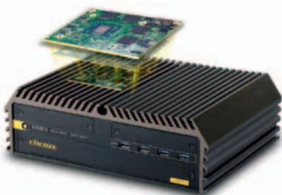
*GM-1000 è un computer rugged che integra a bordo in architettura fanless un'espansione MXM per schede GPU ad alte prestazioni*
