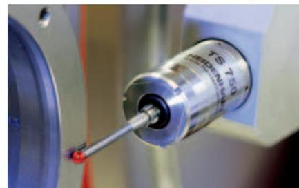
*Il nuovo sistema di tastatura pezzo TS 750 di Heidenhain per rettificatrici: compatto, ultrapreciso, duraturo e robusto per il controllo qualità in-process su rettificatrici*
