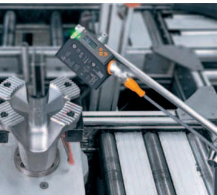
*Il nuovo Profiler PMD di ifm per il controllo qualità in linea*
