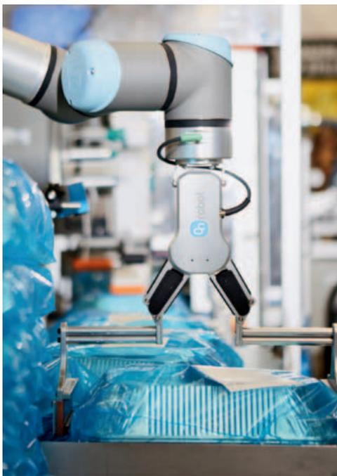
Le pinze RG6 hanno una corsa di 160 mm e sono capaci di sollevare oggetti fino a 6 kg
