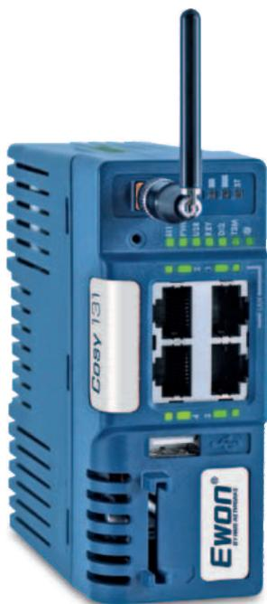
*Ewon Cosy è la soluzione ideale per iniziare. Il router stabilisce una connessione VPN identificata e criptata al server Talk2M e consente un accesso remoto sicuro*
