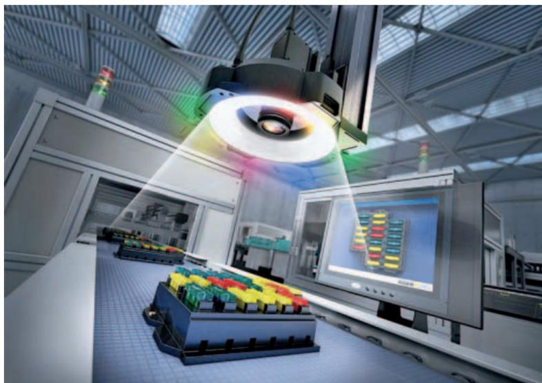
*Sistema Machine Vision per il controllo qualità (fonte: Keyence)*
