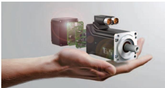
*I motori con azionamento integrato compatti facilitano lo sviluppo e la manutenzione di macchine modulari*
