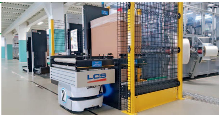
Le scatole vengono prima formate automaticamente e poi trasportate verso i punti di presa dei robot mobili tramite conveyor a rulli. Per permettere lo scambio scatole tra conveyor e robot mobili LD è stata installata a bordo di ogni robot una rulliera motorizzata.
