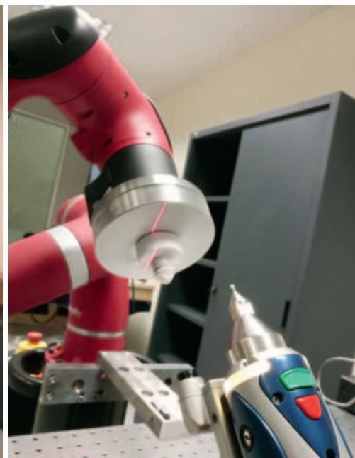
Figura 3 - Esecuzione di una scansione mediante la coordinate measuring machine faro
