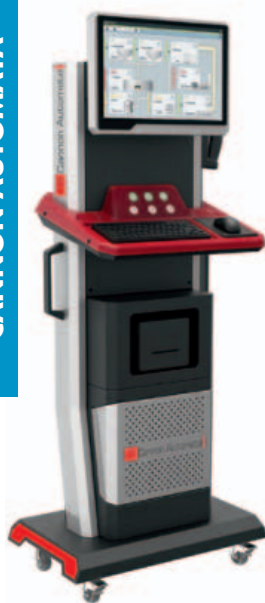
Totem I4.0 è la stazione intelligente con pannello integrato multi-touch da 15", 21,5", 24"
