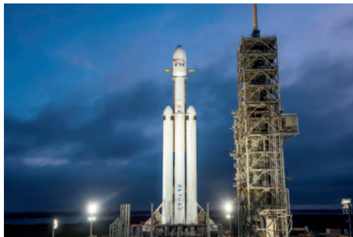
Il vettore Falcon Heavy di SpaceX al decollo: si tratta di un veicolo spaziale capace di mettere in orbita carichi pesanti e in parte recuperabile, con il primo stadio e i due booster che rientrano dallo spazio per essere riutilizzati (fonte: SpaceX)
