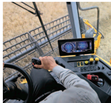
I display ifm hanno grado di protezione (IP67) e tecnologia Optical Bonding che li protegge dall'umidità e garantiscono leggibilità delle informazioni
