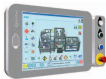
Il Posyc 43XX Smitec è un Panel PC industriale basato su architettura Intel x86 quad core e completo di un display 15" a colori
