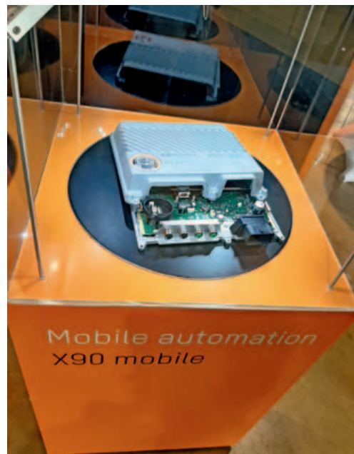
Un moderno sistema di controllo prodotto da B&R, l'azienda che ha ideato Powerlink, è utilizzabile a bordo di veicoli e dotato di connettività Ethernet evoluta (fonte: B&R)
