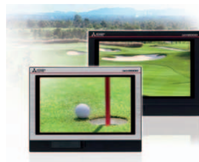
I modelli GT25 WideScreen hanno un formato che garantisce circa il 40% di display in più, con una risoluzione fino a 5 volte maggiore
