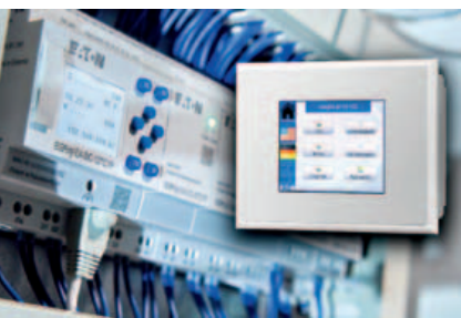
L'HMI XV102 dispone di led-LCD display grafico da 3,5 pollici a colori e risoluzione 320 x 240 pixel
