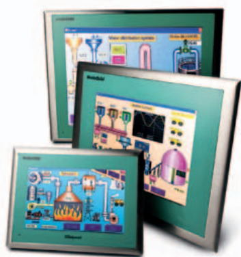
Gli HMI Brainchild sono dotati di CPU Arm Cortex-A8 a 667 MHz, 256 MB di Ram e 128 MB di Flash Memory
