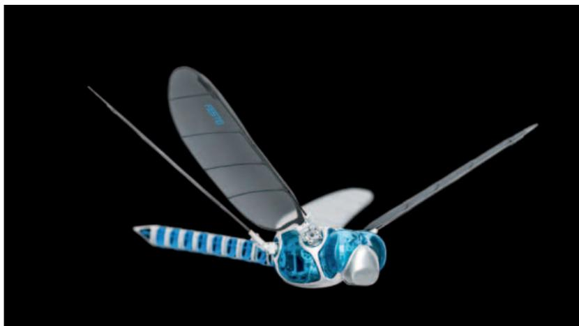
*L'animale bionico che Festo ha proposto a questa edizione di SPS era 'BionicOpter', un grande insetto volante robot che esemplifica le possibilità di controllo e azionamento in tempo reale di un sistema meccatronico complesso*
