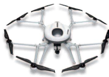
*Per l'ispezione delle condotte, negli USA si sta sperimentando un drone alimentato con celle a combustibile basate sull'idrogeno*
