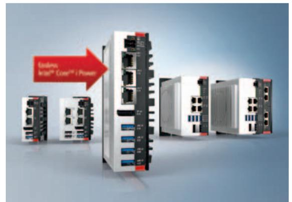
Il nuovo IPC C6025 di Beckhoff, con processore 'Intel Core i' e struttura fanless, è il più recente dispositivo della serie C60xx di PC industriali avanzati, compatti e facili da installare
