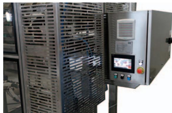
L'operatore interagisce con il sistema di controllo della macchina tramite un HMI basato su un pannello tattile della serie Got GS di Mitsubishi
