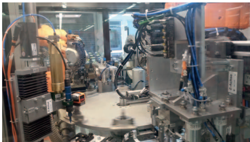
Particolare di un'isola produttiva completamente automatizzata, dove vengono realizzate le bobine per sensori a induzione
