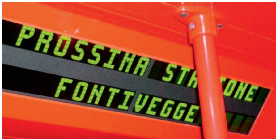
Le vetture, al loro interno, hanno un display luminoso in grado di visualizzare messaggi alfanumerici su due righe
