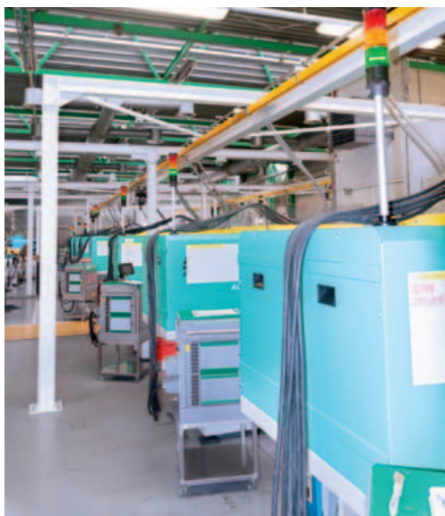
Ogni macchina aveva già una torretta di segnalazione Werma, che è stata velocemente equipaggiata con il modulo supplementare SmartMonitor
