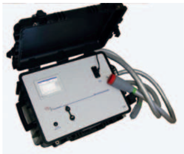
L'analizzatore ETG 6900 P utilizza la spettroscopia laser per misurare la concentrazione di ammoniaca
