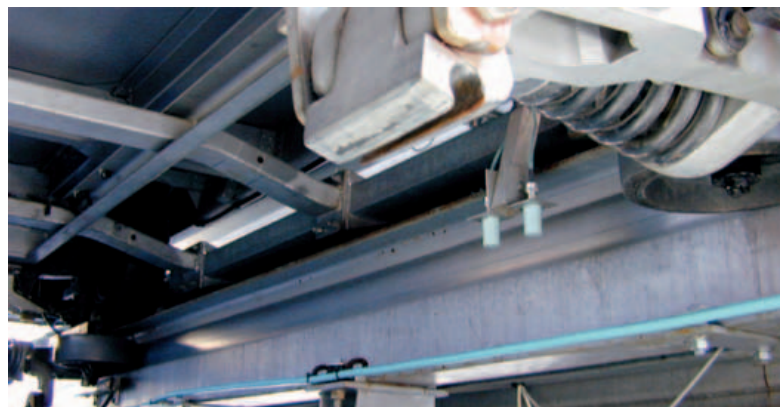
La fune traente dell'impianto rimane in moto costante mentre le vetture, per effettuare la sosta in stazione e la ripartenza, si sganciano e poi si riagganciano automaticamente. La vettura viene rallentata e quindi accelerata mediante una serie di ruote gommate poste sui lati del binario
