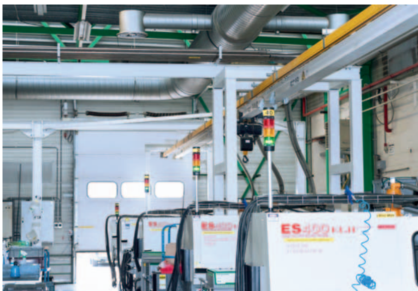
Tutte le 50 macchine a iniezione in Yamauchi sono state dotate di SmartMonitor di Werma, una soluzione wireless integrata nelle torrette di segnalazione che permette la raccolta dati dai macchinari
