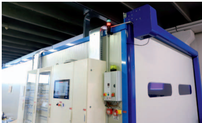
L'area 'a caldo', con visibile il quadro elettrico e il pannello dell'interfaccia Scada, dove sono effettuati test e collaudo dei chioschi di gaming destinati al mercato degli Stati Uniti
