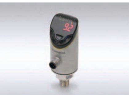
Il sensore serie PS+ di Turck Banner Italia registra in automatico se il controller o il modulo bus richiede un segnale PNP o NPN
