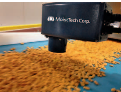
Il sensore IR3000 fornisce misurazioni accurate di umidità durante tutto il processo, garantendo una qualità del prodotto costante dal laboratorio alla linea
