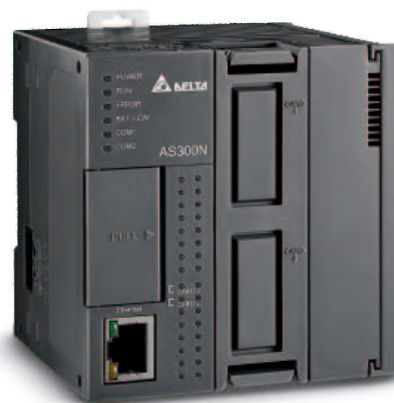
Con il protocollo CANopen integrato, i controllori Delta Compact Modular Midrange PLC AS, insieme con la scheda di comunicazione AS-FCOPM, consentono di gestire fino a otto assi
