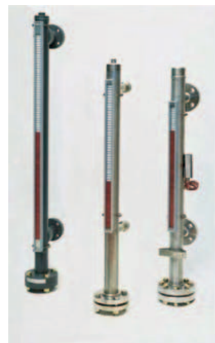
L'indicatore di livello Serie 2000 di Officine Orobiche misura liquidi a temperature fino a 500 °C e fino a -196 °C
