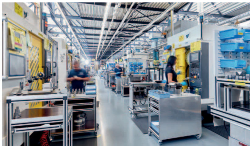
In Neugart la base dell'elevato grado di flessibilità ed efficienza necessario per la produzione è costituita dalla catena logistica interna, che sfrutta con coerenza i potenziali di ottimizzazione con il ricorso a metodi quali forme a U, treni rimorchiatori, SMED e kanban
