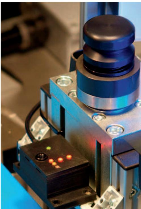
*Sensore di temperatura ad alta velocità montato su un impianto*
