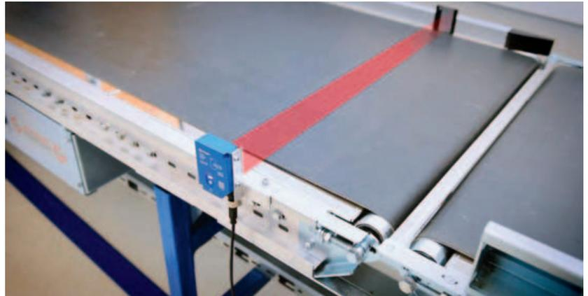
*La nuova serie di sensori optoelettronici di Wenglor comprende differenti modelli, caratterizzati da diverse ampiezze del fascio luminoso*
