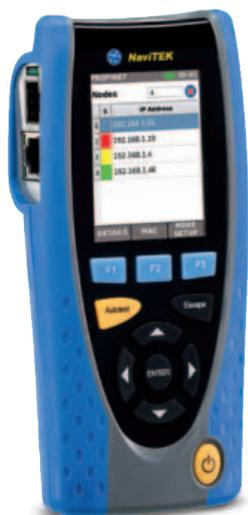
*NaviTek IE è uno strumento palmare per system integrator e IT Manager che installano e gestiscono reti Profinet Industrial Ethernet e reti Ethernet IP standard*
