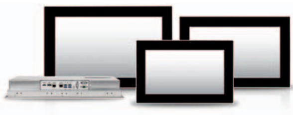
I PC Beijer C2 possono funzionare come server e client OPC UA, con funzioni di interconnessione standard
