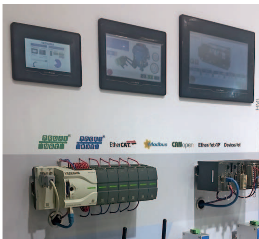
I pannelli HMI insieme al micro PLC evoluto di Vipa: delle soluzioni di visualizzazione e controllo estremamente compatte e versatili
