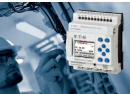
easySoft 7 consente la scelta tra quattro linguaggi di programmazione: LD (Ladder Diagram); easy Programming (EDP); Function Block Diagram (FDB) e Structured Text (ST)
