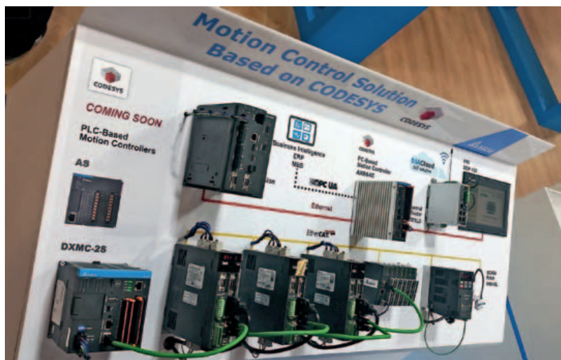
Un'installazione che esemplifica la piattaforma estesa e flessibile, basata su Codesys, che Delta è in grado di proporre ai produttori e integratori di macchine e impianti
