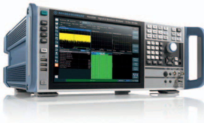
Rohde & Schwarz offre degli analizzatori di spettro ideali per effettuare i test e l'analisi ad alta velocità del 5G NR, per laboratorio e produzione (nella foto FSV 3030)
