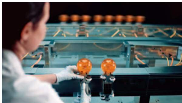
I sistemi di trasporto Trak di B&R oggi sono in grado di realizzare anche applicazioni collaborative, conciliando alte prestazioni e sicurezza
