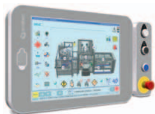
Il Posyc 43XX Smitec è un Panel PC industriale basato su architettura Intel x86 quad core con display da 15 pollici a colori
