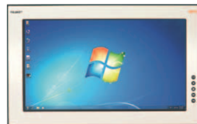
I monitor Polaris Remote permettono il trasferimento del segnale video, tastiera e mouse da un PC posto in zona sicura
