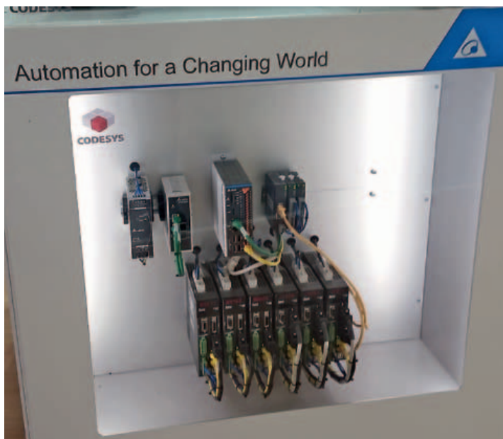
I drive e il sistema di controllo, sviluppato con Codesys, che gestiscono un'applicazione dimostrativa di mecatronica
