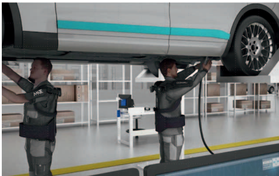
Una simulazione dell'utilizzo di esoscheletri in ambito automotive (Fonte: Comau)
