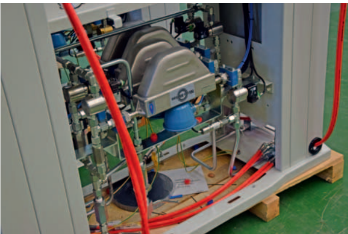
Un erogatore Graf DNG per il gas naturale con i misuratori massici Micro Motion CNG 050 di Emerson
