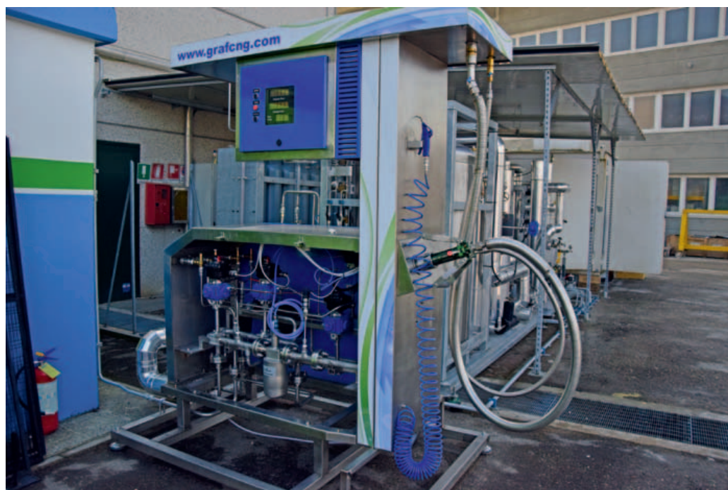
Erogatore Graf di metano liquido con soluzione di misura Micro Motion LNG di Emerson
