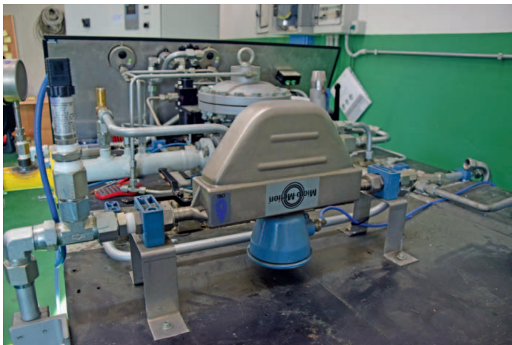
Un misuratore massico Micro Motion di Emerson nell'area di testing e validazione
