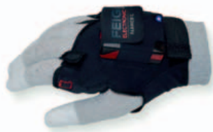
HyWear compact, il dispositivo indossabile di Panmobil, permette di eliminare alcune operazioni come impugnare un dispositivo e attivare lo scanner
