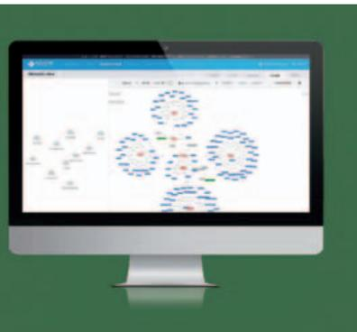
*La soluzione ScadaGuardian, appena installata, aiuta a ricostruire la struttura dell'architettura di rete*
