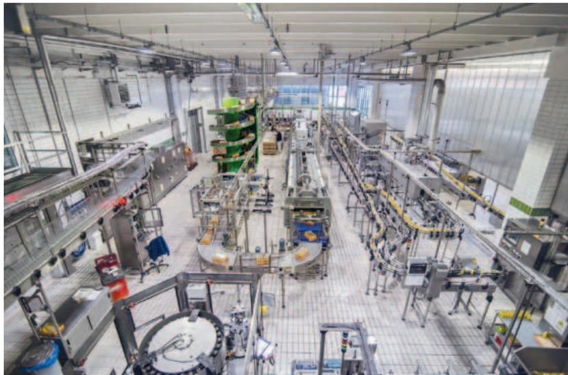
*Linea completa, il risultato della soluzione VLS-pro di Smitec, il pacchetto hardware e software configurabile che permette di controllare fino a 100 nastri trasportatori e gestire la sincronizzazione con i sistemi presenti nella linea di movimentazione*
