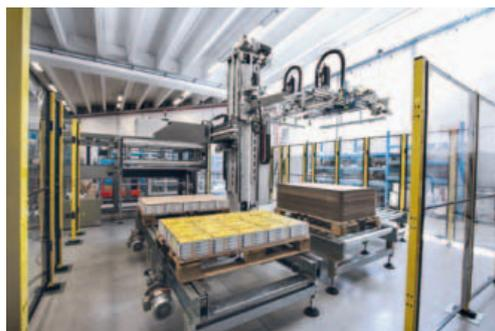
*Palettizzatore con testa magnetica, una soluzione adatta per i prodotti con la parte superiore realizzata in ferro (ad esempio lattine in banda stagnata e vasetti di vetro con tappo di ferro) anche esso gestito grazie alla soluzione Motor Net System (MNS)*
