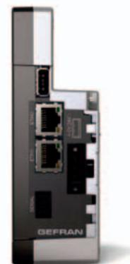
*Il GF Connect è un IOT gateway con web server integrato, basata su un sistema OpenVPN e SSL*
