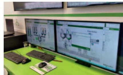
Con EcoStruxure Machine Scada Expert, Schneider Electric propone un'interfaccia HMI per le soluzioni Scada di processo
