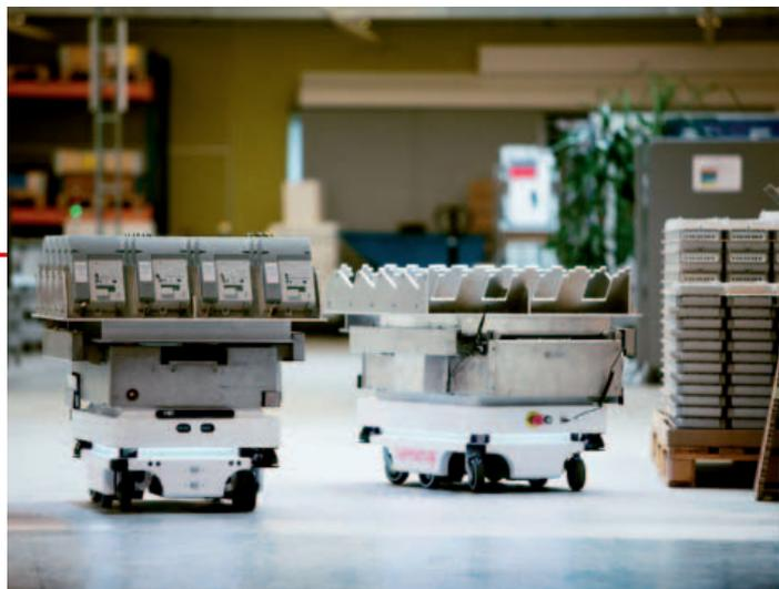
*I robot mobili autonomi (AMR), come quelli proposti da MIR - Mobile Industrial Robots, possono cambiare la loro missione e lo stesso robot può eseguire una serie di compiti differenti in diversi luoghi*
