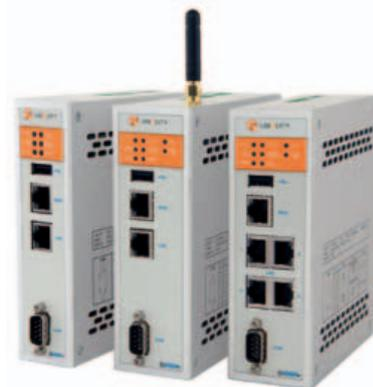
*I sistemi RK20, RK21, RK22 Asem sono basati sul sistema operativo Linux e processore Arm Cortex A7/M4 (i.MX7) a 1 GHz*
