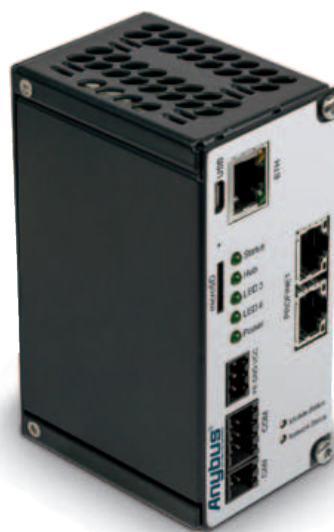
Figura 2 - Il gateway Anybus Edge collega diverse reti industriali al cloud (fonte: HMS)
