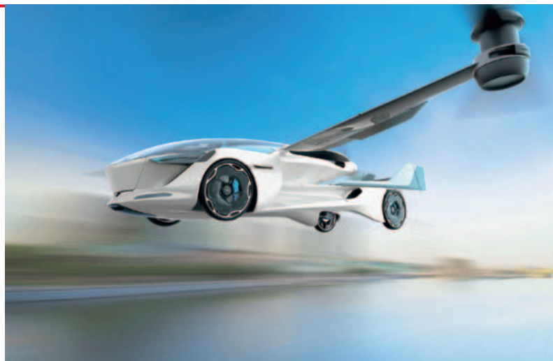
Il progetto AeroMobil 5.0 è di un veicolo a quattro posti con capacità di decollo e atterraggio verticale (Copyright Aeromobil)
