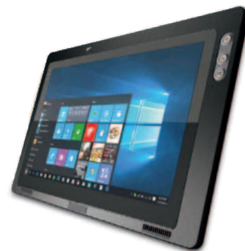
Il Tablet PC N0Q1, sviluppato e prodotto da MSI, è basato su processore dual core Intel Celeron N3010 con frequenze fino a 2.24 GHz e TDP di 4 W
