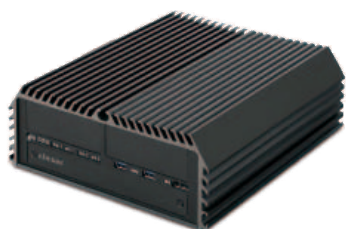
La serie DS-1200 supporta diverse tecnologie avanzate tra cui memorie DDR4 a 2666 MHz, porte USB 3.1 (Gen2) e supporto per SSD PCIe4 NVMe ad alta velocità
