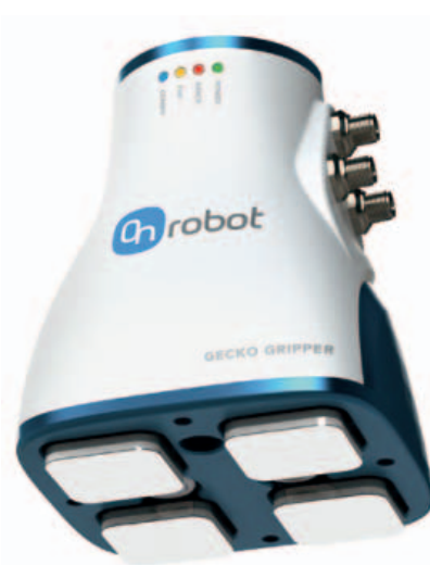
Il manipolatore Gecko, prodotto da On Robot, utilizza milioni di fibre micro-strutturate che aderiscono alle superfici usando la forza di van der Waals
