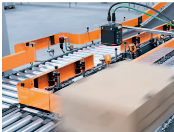
03D rileva volume, dimensione e orientamento degli oggetti
