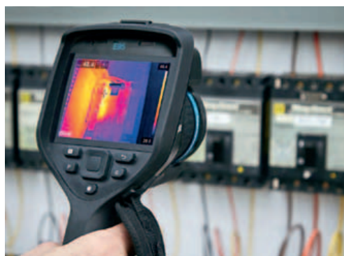
Esempio di termocamera utilizzata per manutenzione predittiva
