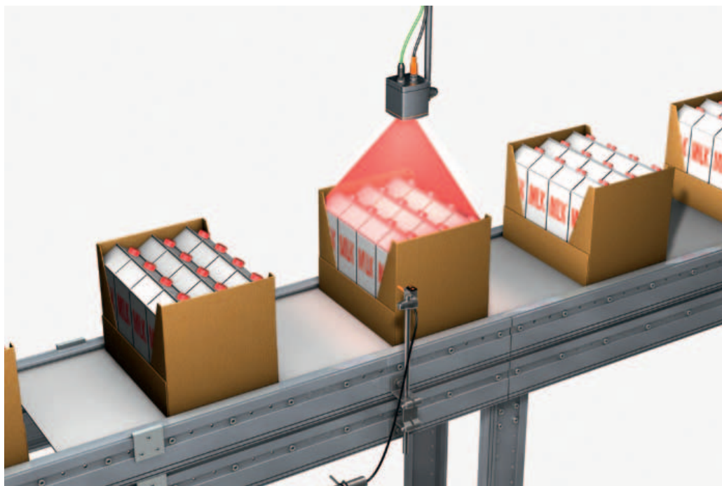
03D rileva il corretto riempimento della confezione
