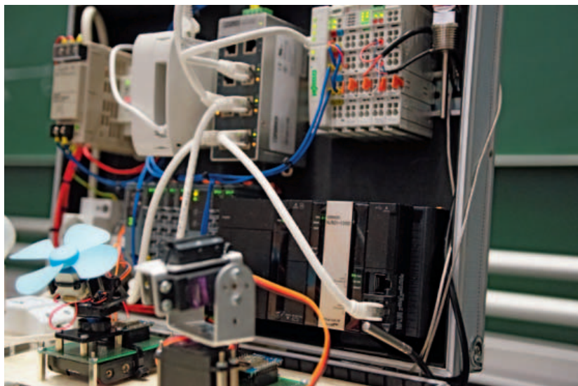
Dettaglio della scatola: il controller macchina a 64 assi multifunzione NJ501 di Omron, compatto e potente. Il controller, il controllo di movimento, la robotica, l'MQTT e l'OPC/UA sono inclusi
