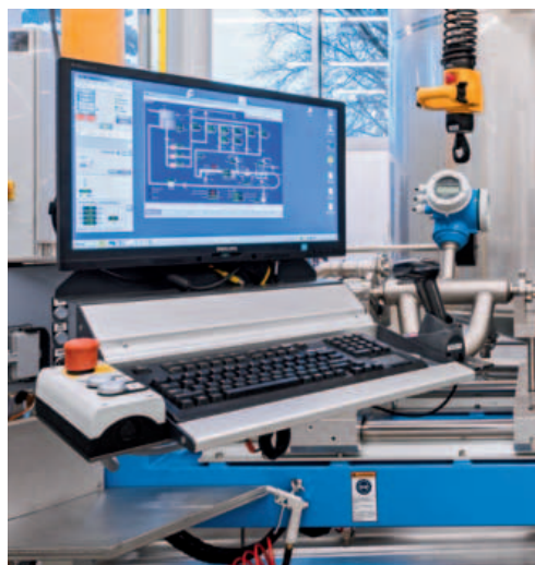
Postazione dell'operatore al banco per la taratura di portata
