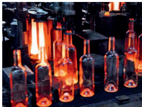
Figura 2 - Ottimizzando la geometria dei contenitori di vetro, è possibile ridurre il consumo di materie prime e di energia necessarie per la fabbricazione, senza compromettere le caratteristiche meccaniche del prodotto
