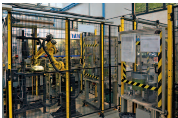
Figura 1 - Un esempio di macchina con dispositivi di sicurezza contro l'intrusione pericolosa
