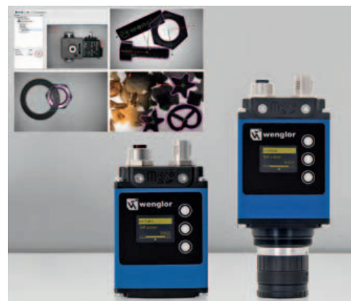
I sensori weQube di Wenglor utilizzano la visione artificiale per il controllo qualità e il riconoscimento di oggetti
