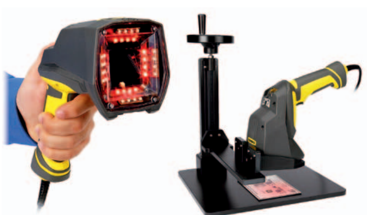
Il sistema di verifica DataMan 8072 analizza le prestazioni dei codici DPM
