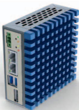
BM100 è l'embedded IPC super compatto (100 x 100 x 43 mm) di Asem
