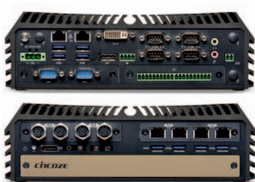
Due modelli dell'IPC DX-1000: con 10 digitali opto-isolati (sopra) e con interfacce per Lan con Power-over-Ethernet
