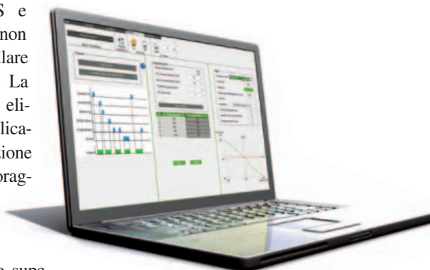
Il software Wago Energy Data Management, precaricato sui PFC 200, rileva automaticamente gli I/O collegati e consente il monitoraggio energetico senza bisogno di un applicativo di livello superiore
