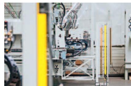
*Le barriere fotoelettriche di sicurezza Wenglor di tipo 4 - PLe sono progettate per proteggere l'operatore in punti di pericolo con particolare riferimento alle dita e alle mani*
