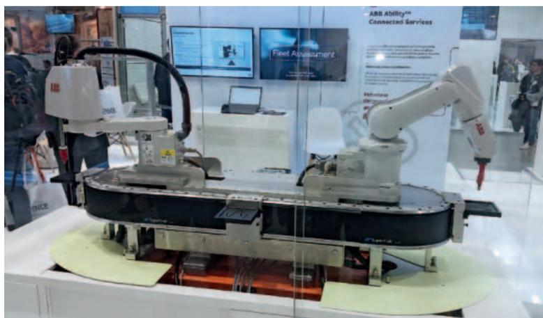
*Alla fiera Mecspe di Parma, era possibile vedere come il sistema di trasporto SuperTrak, di B&R Automazione, sia in grado di coordinarsi in hard real-time con i robot ABB*
