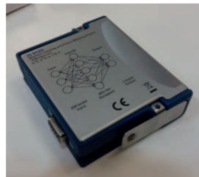
Il modulo che incorpora uno strato di rete neurale e permette di attuare strategie di deep learning su un controllore industriale compatto
