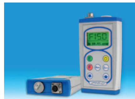
Sulla tastiera del F150 di Picotronic, è stato dedicato un apposito tasto Rec che permette la registrazione in real time dei dati in acquisizione
