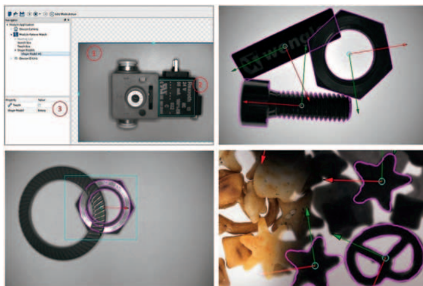
Figura 5 - Il modulo weQube Vision con pattern matching utilizzato insieme alla fotocamera intelligente weQube consente di realizzare applicazioni di elaborazione delle immagini, anche complesse, in modo rapido ed economicamente vantaggioso
