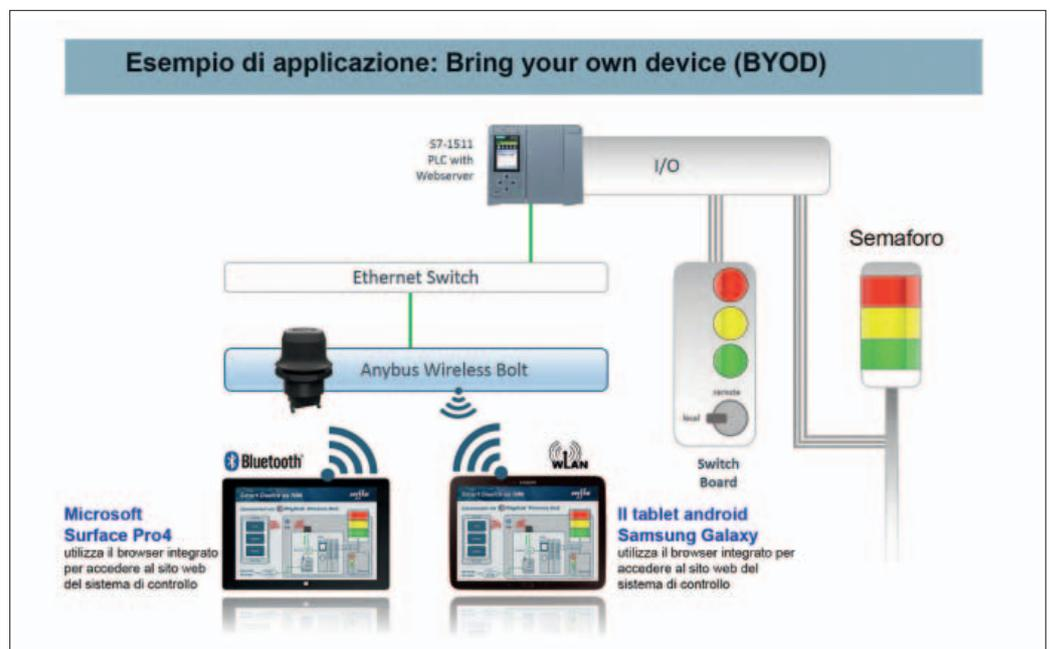
*Attraverso Anybus Wireless Bolt, il tablet accede al webserver del PLC*
