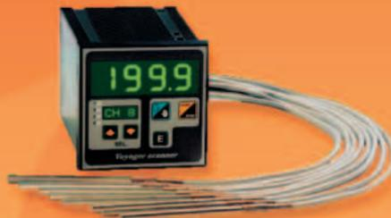
Voyager scanner è in grado di leggere contemporaneamente fino ad 8 ingressi PT100, termocoppie J e K, segnali analogici Volt/mA. Dispone di 5 relè per la segnalazione di vari allarmi e soglie ed evidenzia le varie segnalazioni con un chiaro display alfanumerico a scritte scorrevoli. Tramite la seriale o la stampante è possibile leggere e stampare i valori memorizzati.
