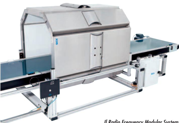
*Il Radio Frequency Modular System è un tunnel per il rilevamento di colli singoli sul nastro trasportatore*
