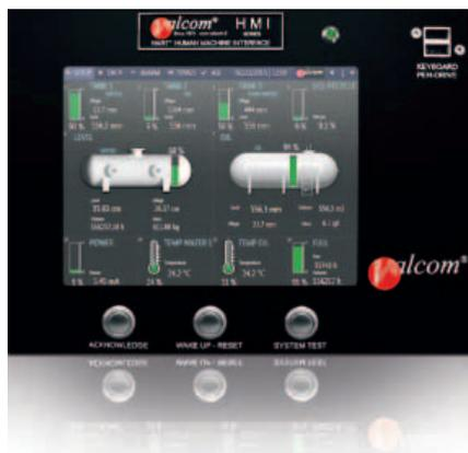
ture, controllare il livello di un serbatoio, monitorare la fasi di carico e scarico, cambiare il valore del peso specifico del fluido, modificare il campo di misura del sensore e settare nuovi allarmi: tutto questo sia restando nei pressi dell'installazione stessa sia dal proprio ufficio operativo, mentre l'installazione continua a trasmettere i dati alla centrale. Naturalmente, il sistema è in grado di effettuare **il calcolo di volume e massa** per gli indicatori di livello.
