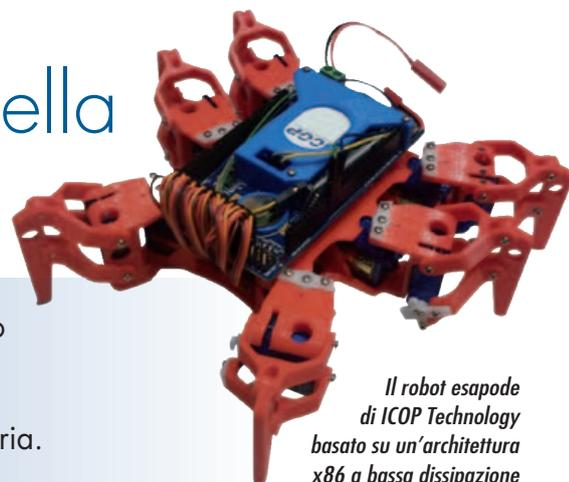
*Il robot esapode di ICOP Technology basato su un'architettura x86 a bassa dissipazione*
