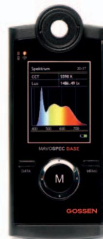
MavoSpec Base di Gossen Metrawatt è un analizzatore dello spettro luminoso emesso da sorgenti Led, Oled e da lampade comuni
