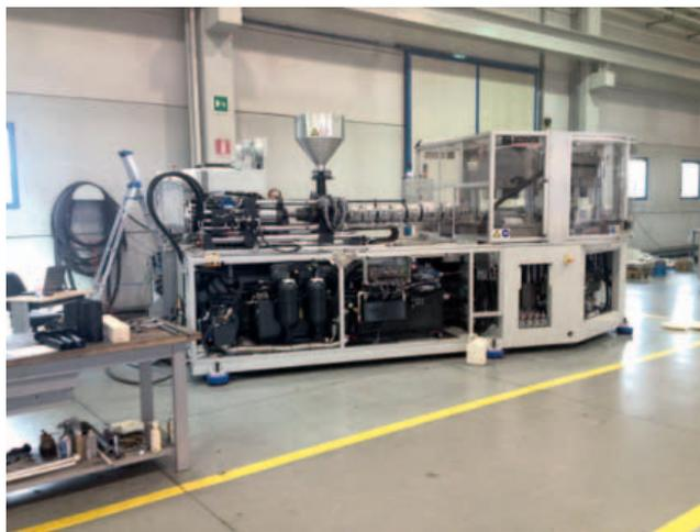
*La macchina per l'estrusione che utilizza gli inverter della nuova serie D Frame di Danfoss*
