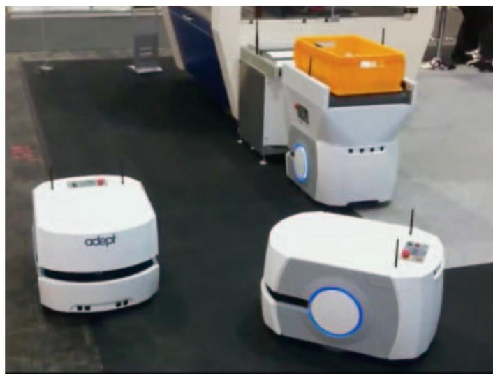
*Il veicolo a guida automatica per la logistica Lynx di Omron-Adept Technologies*
