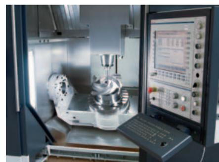
*IndraMotion MTX advanced con un solo hardware di controllo può arrivare a gestire fino a 250 assi in 60 canali NC indipendenti*
