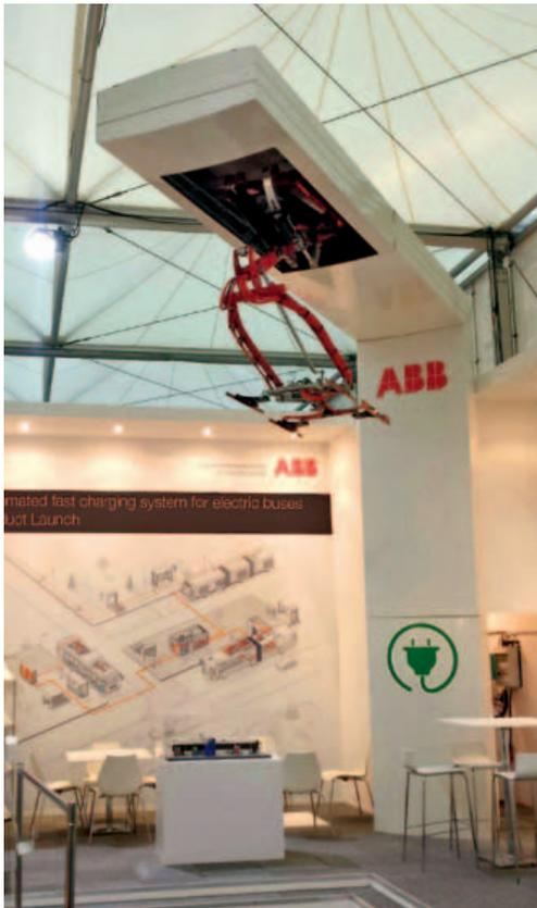
*Il sistema di collegamento automatizzato utilizza un classico pantografo come quelli tradizionalmente installati su treni, tram e metropolitane, montato però in posizione rovesciata su un'elegante infrastruttura*
