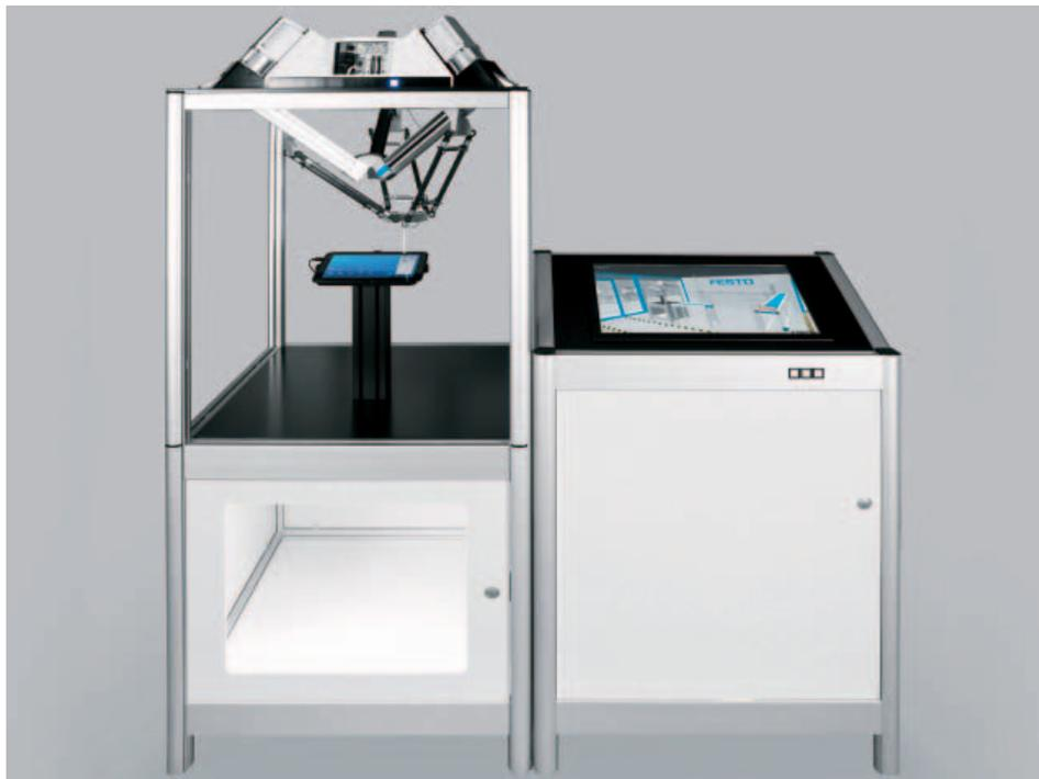
*Un robot delta, realizzato con tecnologia Festo, che non necessita di armadio di controllo. Questo sistema di manipolazione unisce il livello di controllo di un master con gli elementi di campo*
