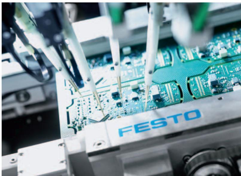
La fase di test nella produzione dell'elettronica di Festo
