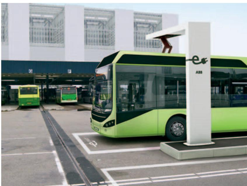
*Grazie al sistema di collegamento sul tetto e a tempi di ricarica medi di 4-6 minuti, la soluzione di ABB può essere facilmente integrata sui modelli di autobus già in circolazione, installando unità di ricarica rapida presso stazioni di capolinea, terminal, depositi e/o fermate intermedie*
