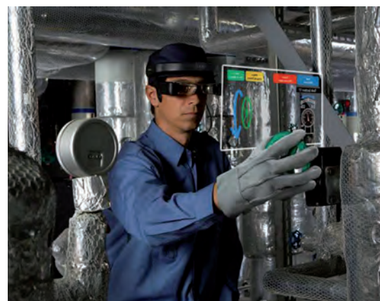
Figura 3 - Smart Glass per il controllo, la manutenzione e il monitoraggio di impianto (National Instruments)
