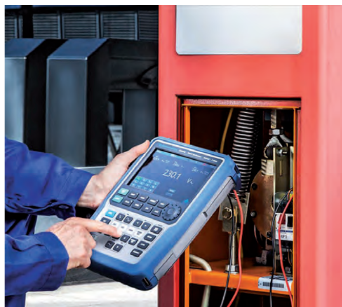
La versione a due canali di Scope Rider RTH opera anche come multimetro digitale
