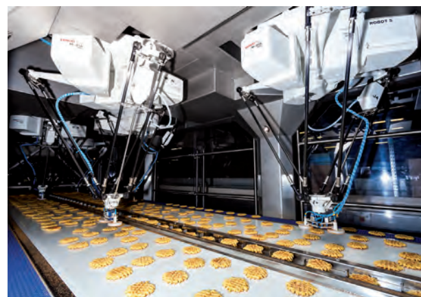
I robot delta M-2iA di Fanuc automatizzano il packaging di una delle linee di produzione del biscottificio belga Biscuiterie Thijs
