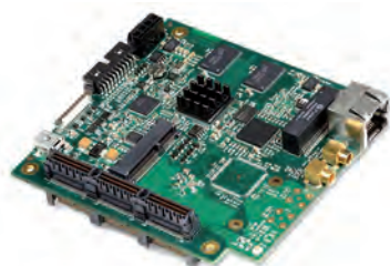
StreamCorder-HD-DMI di Sisav è una soluzione stand-alone basata sul formato PCIe104
