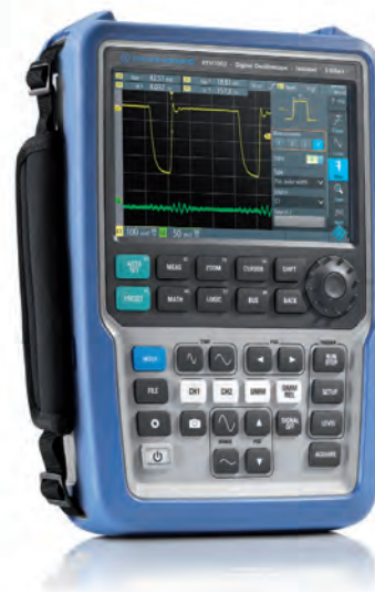
Il nuovo oscilloscopio digitale portatile di Rohde & Schwarz ha un'ampiezza di banda fino a 500 MHz e frequenza di campionamento di 5 GS/s
