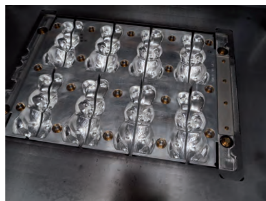
Stampi di policarbonato per la produzione di coniglietti pasquali
