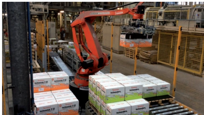
Comau Smart Pal in azione nella pallettizzazione di scatole
