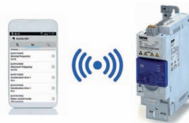
Gli inverter i500 di Lenze possono essere controllati anche da smartphone
