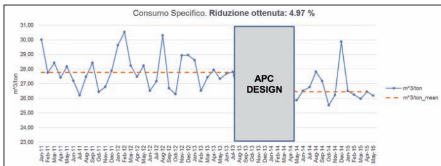
Figura 9 - Andamento del consumo specifico di gas naturale prima e dopo l'installazione dell'APC: consumo specifico mensile (linea blu) e valor medio del consumo specifico (linea rossa tratteggiata)
