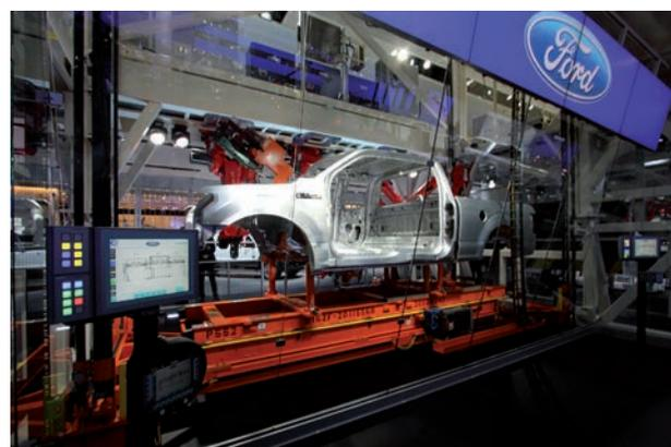
*Per il nuovo pick-up Ford F150 è stata prodotta, per la prima volta, una scocca interamente in alluminio*
