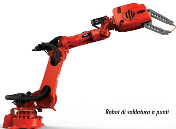
Robot di saldatura a punti
