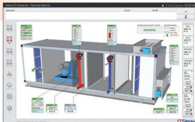
Una schermata dell'interfaccia Scada di un'Unità di Trattamento Aria (UTA) di una camera bianca
