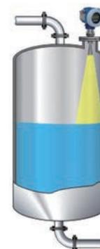
Figura 2 - Applicazione di misura radar (fonte Endress + Hauser)
