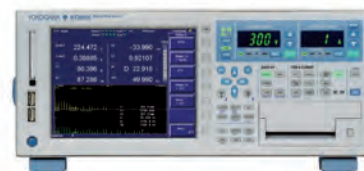
WT3000E di Yokogawa misura la potenza elettrica, per la calibrazione di strumenti per la misura dell'efficienza energetica
