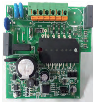
Le schede per azionamenti brushless e sensorless di Intea Engineering
