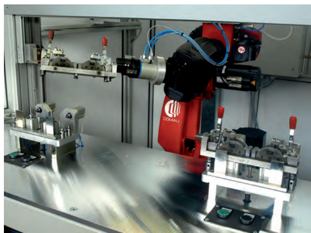
Visione frontale della cella di saldatura laser con le due postazioni di presa. Il robot sta simulando l'ingresso nella cella del particolare da saldare
