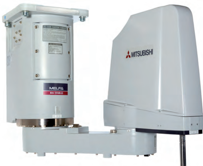
Il robot Scara RH-1FHR-D è una delle novità più recenti della proposta di Mitsubishi Electric
