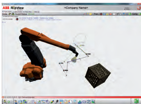
Il software di supervisione RobView 5 di ABB per robot di verniciatura
