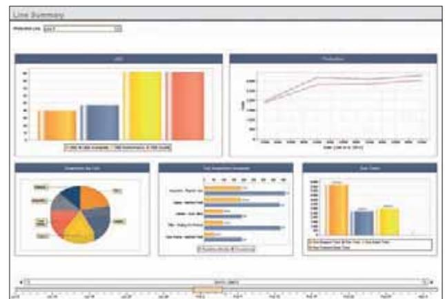
*Ignition è un software HMI/Scada/Mes che utilizza database e tecnologie Web*
