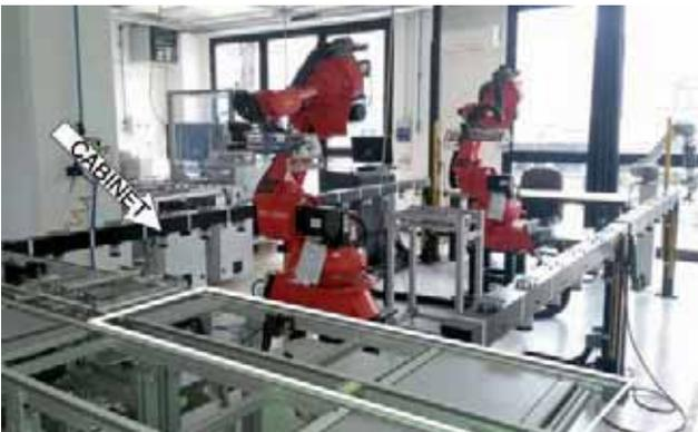
Figura 1 - Impianto per la riparazione, lo smontaggio e il riciclaggio di circuiti stampati
