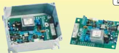
**AMPLIFICATORE PER CELLE DI CARICO AD ALTA PRECISIONE, VERSATILE, SEMPLICE DA USARE ED ECONOMICO, FUNZIONA PERFETTAMENTE IN QUALSIASI CONDIZIONE AMBIENTALE.**
