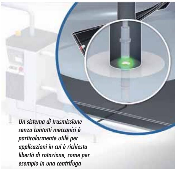
*Un sistema di trasmissione senza contatti meccanici è particolarmente utile per applicazioni in cui è richiesta libertà di rotazione, come per esempio in una centrifuga*
