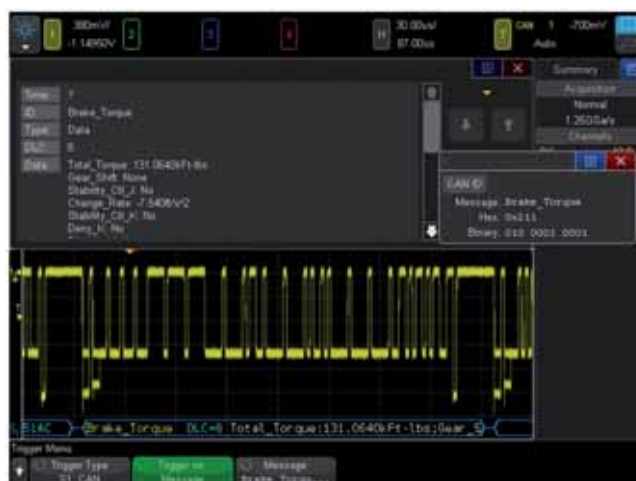
Figura 2 - Dimostrazione visiva della procedura di arbitraggio con un oscilloscopio
