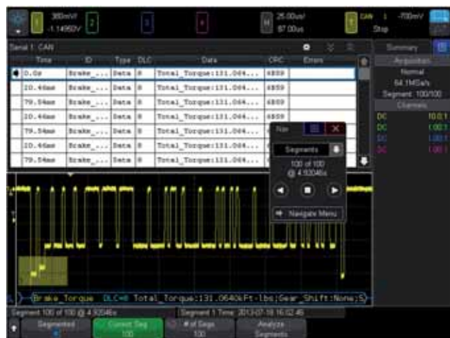
Figura 4 - Uso della memoria segmentata per caratterizzare la frequenza di occorrenza dell'arbitraggio
