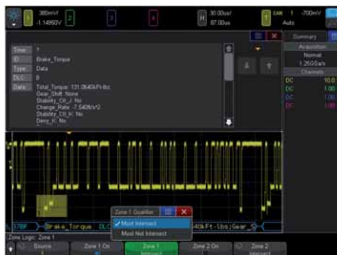
Figura 3: Utilizzo del trigger di zona per la sincronizzazione sui bit di arbitrazione
