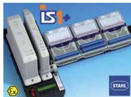
Il sistema di I/O remoto IS1+ di R. Stahl offre molte nuove funzioni per la sicurezza in impianto
