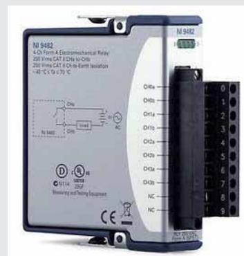
*Uno dei nuovi moduli di I/O ad alta tensione C Series di National Instruments (NI 9482)*
