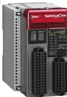
SafetyOne può sostituire fino a sei moduli di sicurezza
