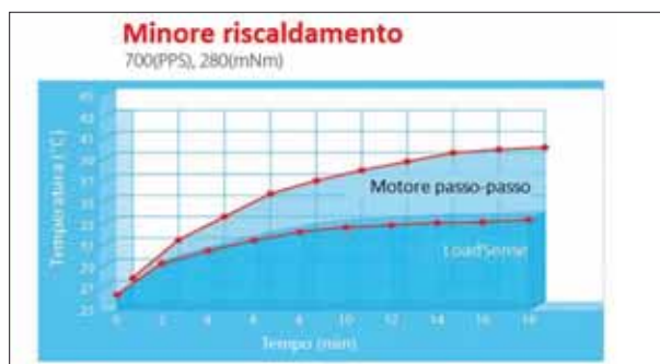
Figura 3 - La regolazione di corrente permanente della tecnologia LoadSense fa sì che il motore si riscaldi molto meno di un motore passo-passo standard
