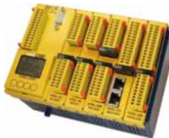
Safeline permette cablaggi e logiche di macchina in categoria 4 già conformi a Sil3
