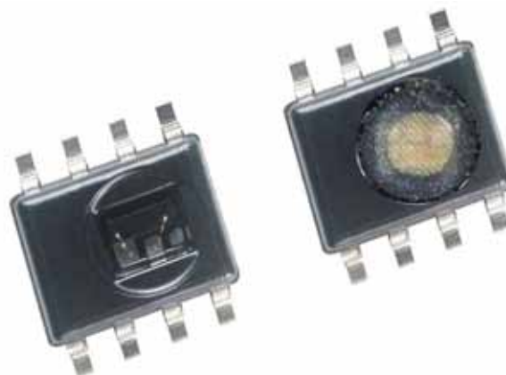
Il sensore HIH-6130 è disponibile anche nella versione HIH-6131 (a destra) resistente alla condensa
